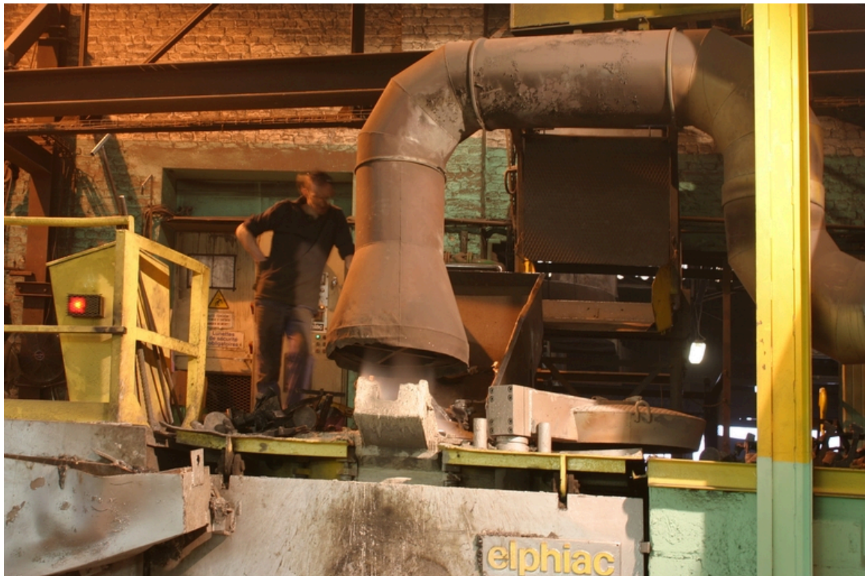
Chargement d'un four.
