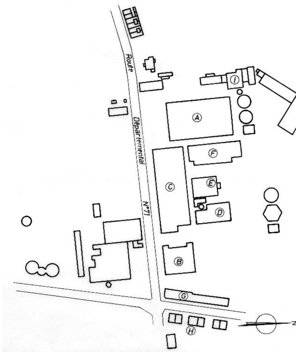
Schéma de situation : A. Atelier de fabrication, B. Atelier de fabrication et four à chaux, C. Atelier de fabrication, D. Atelier, E. Chaufferie, F. Atelier et magasins, G. Cantine, H. Logement ouvriers, I. Bureau.
