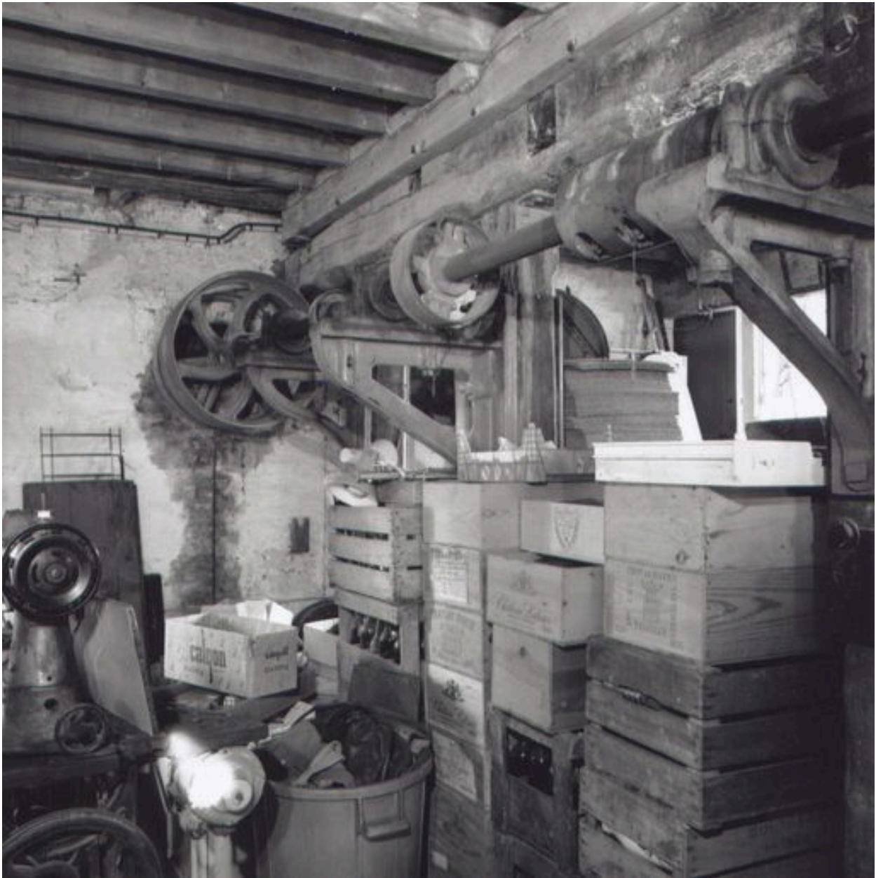
Arbre de transmission horizontal équipé des poulies au rez-de-chaussée de la minoterie.
