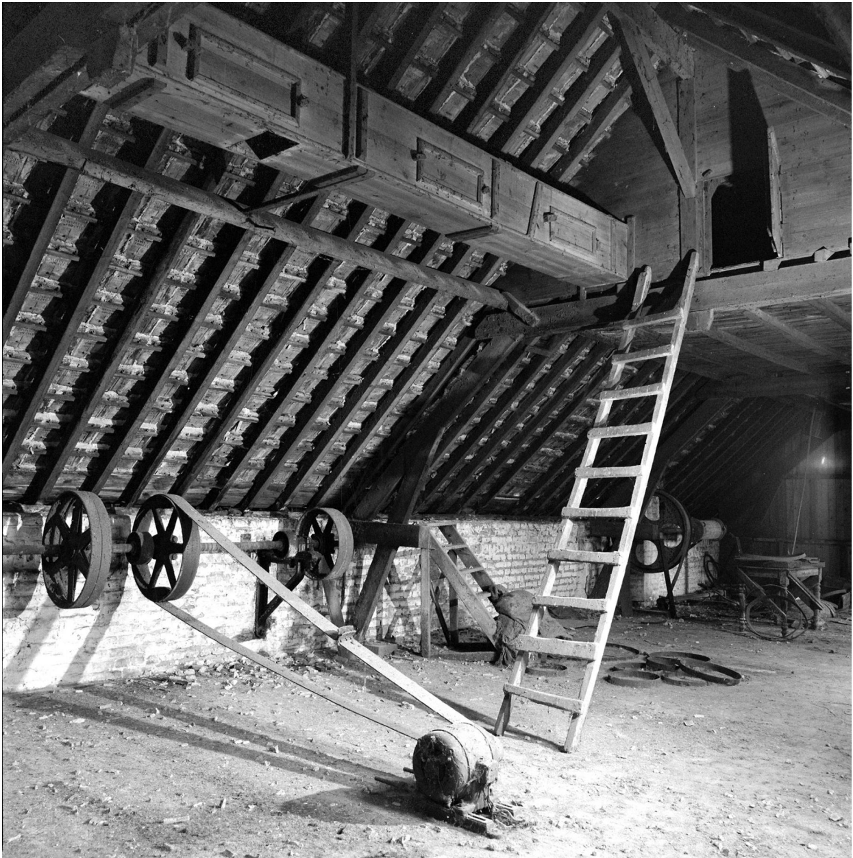
Malterie. Dispositif de transmission et d'acheminement de l'orge par courroie à godets.
