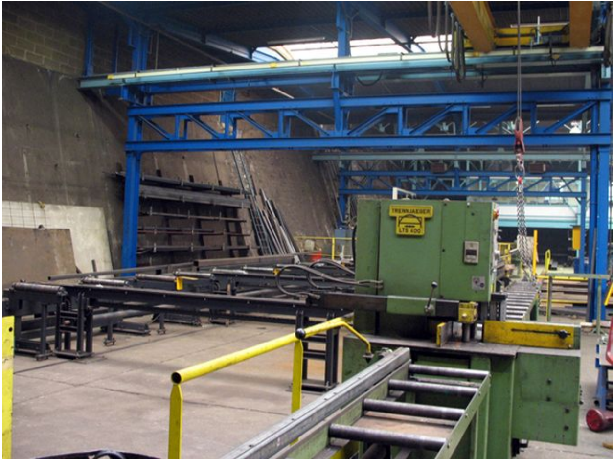
Machine de coupe et de perçage des charpentes.
