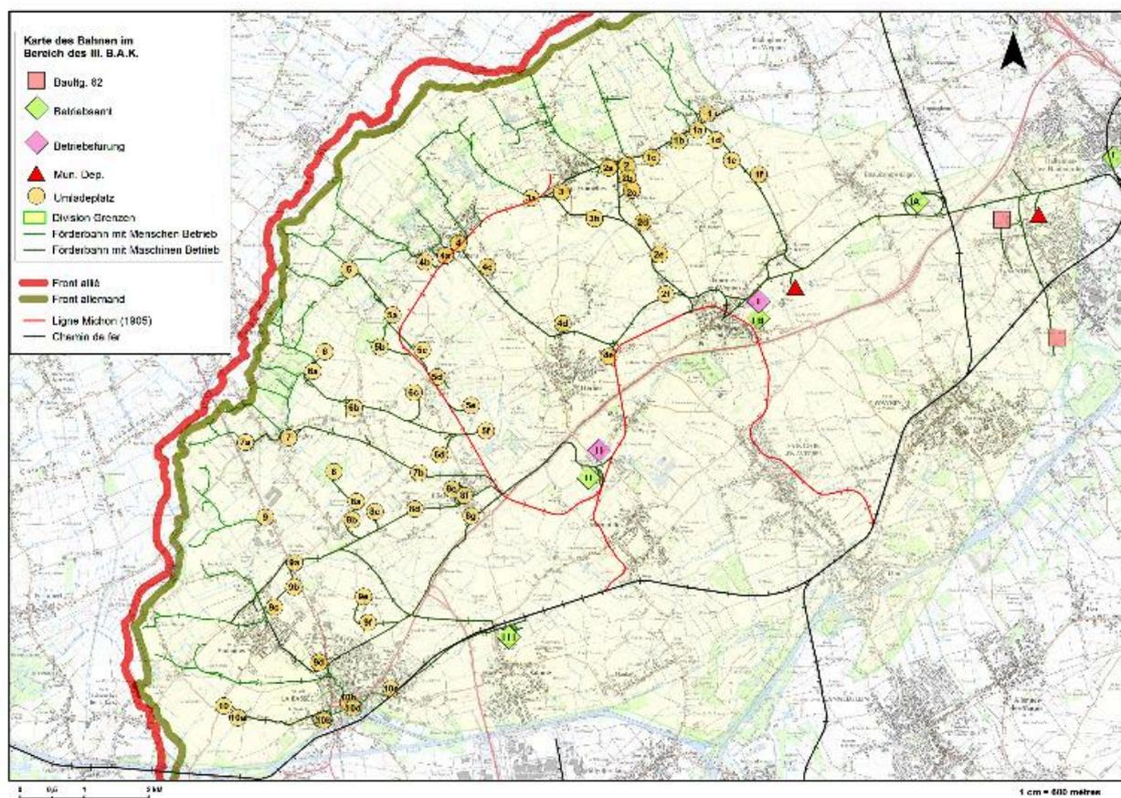
Implantation des garnisons, voies d'acheminement et dépôts de matériel allemand d'après deux plans du 20/07/1916 (étiquettes colorées) et du 30/07/1917 (indications en lettres italiques noires). La ligne Michon est une ligne de chemin de fer privée annexée par l'armée allemande à son arrivée.
