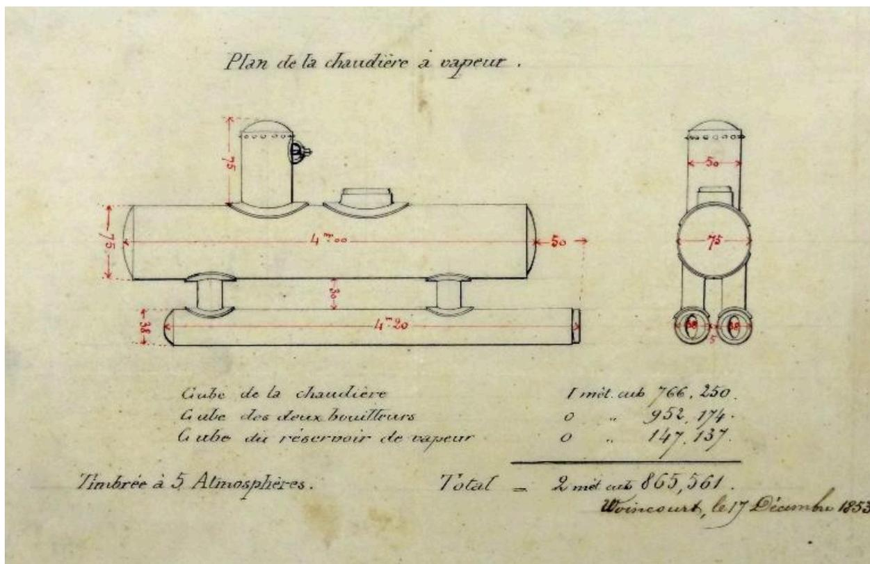
Plan de la chaudière à vapeur installée dans l'usine en 1853.
