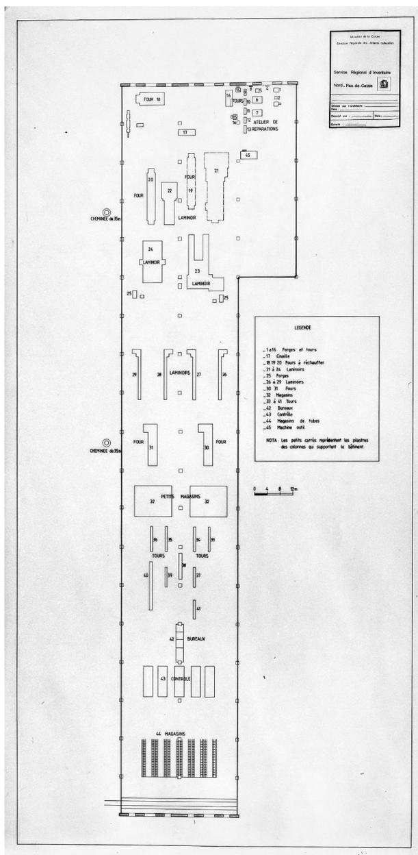
Plan au sol de l'atelier de fabrication avec la position des machines en 1907 (Usine B) (AD Nord ; M417720).
