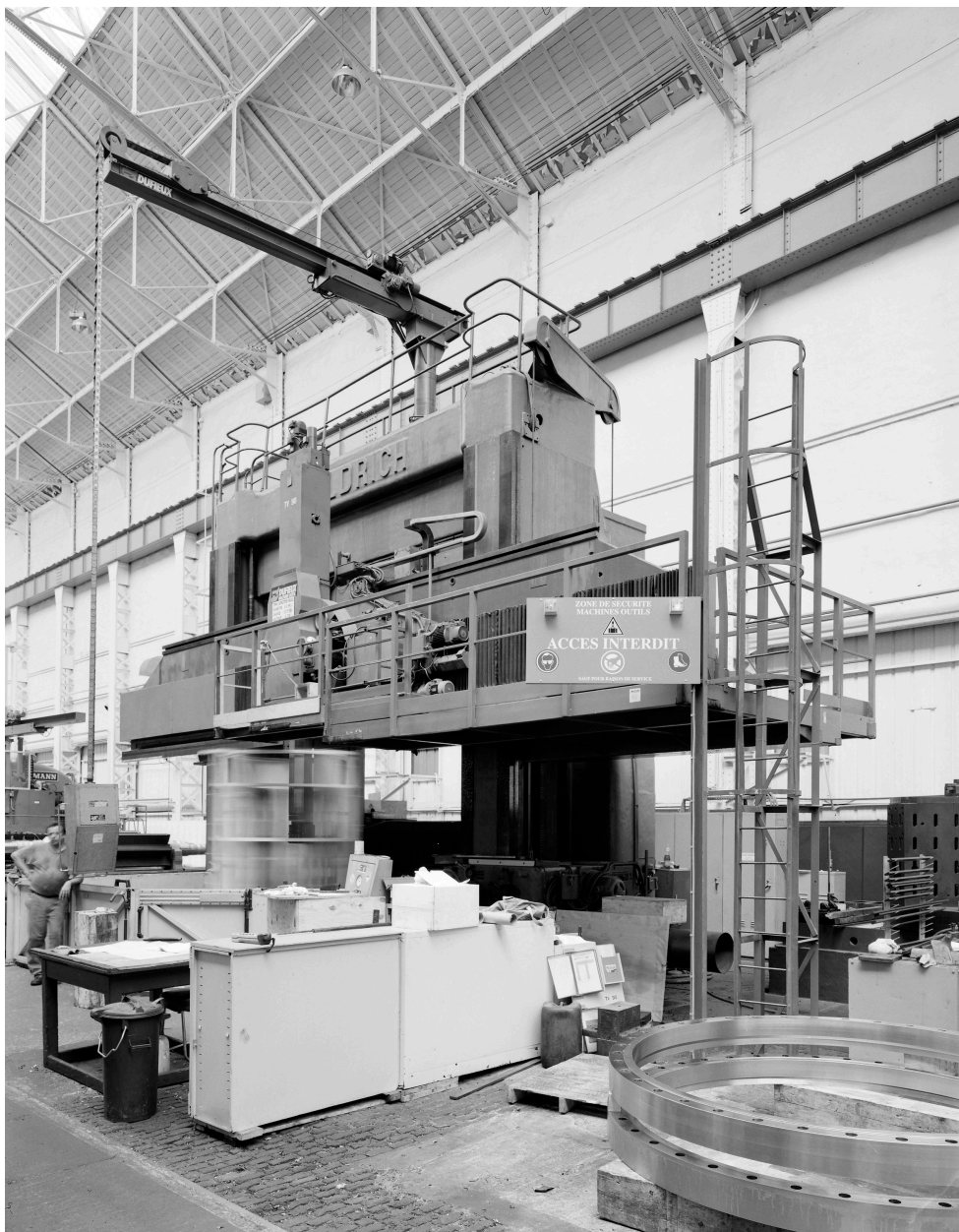
Le tour vertical Waldrich, halle 10 nord, atelier de grosse mécanique.
