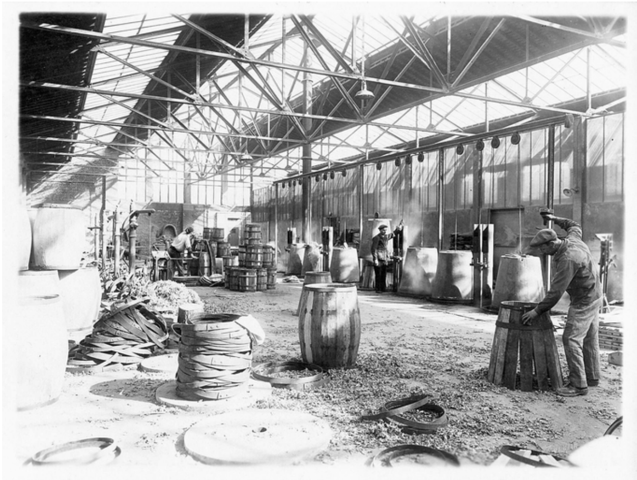
Les cloches de vapeur pour le cintrage et une cercleuse, 1927 (Société Fermière des Etablissements Allard - Statuts).
