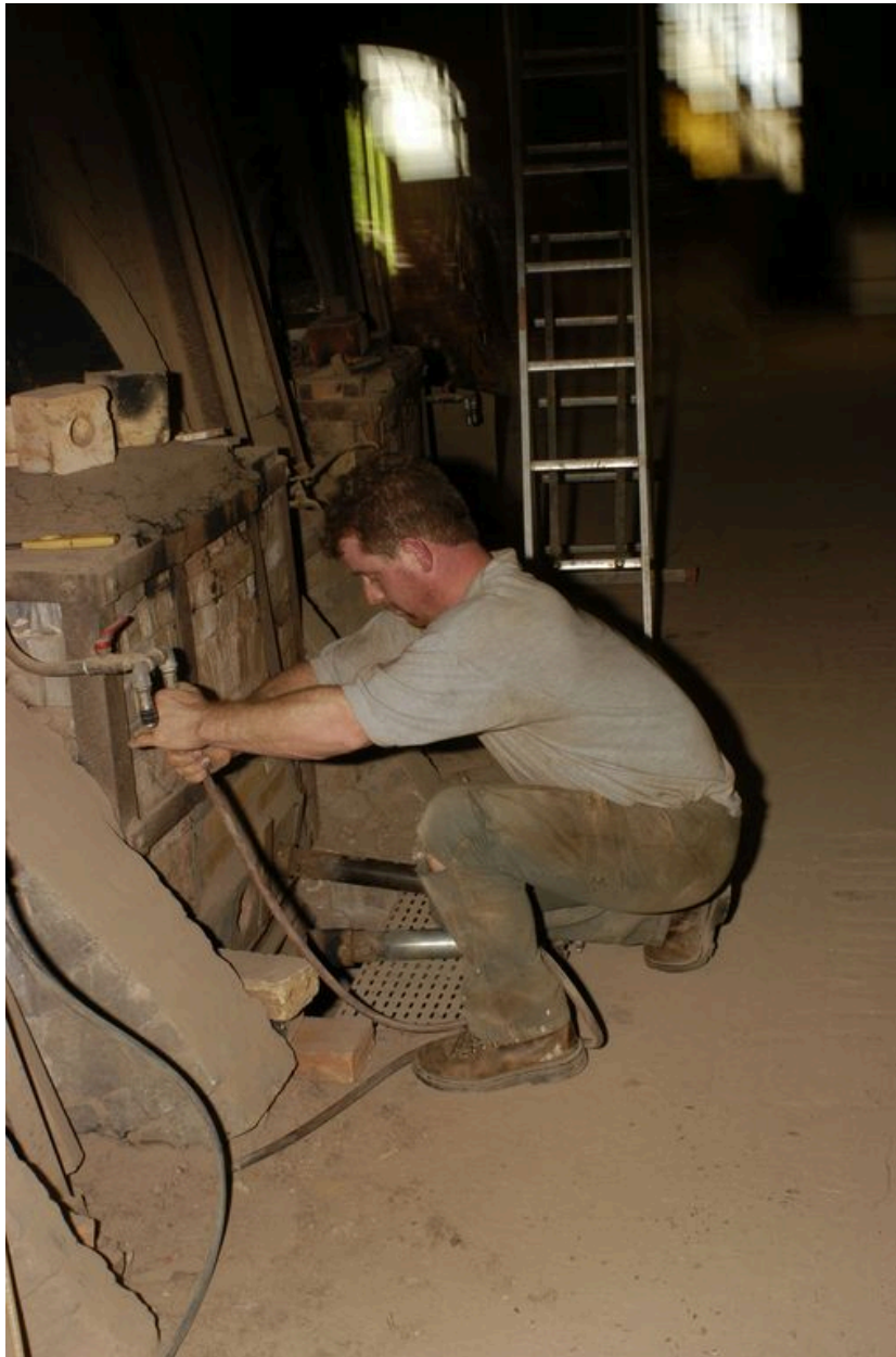
Raccordement des flexibles de gaz au brûleur, avant l'allumage du four.
