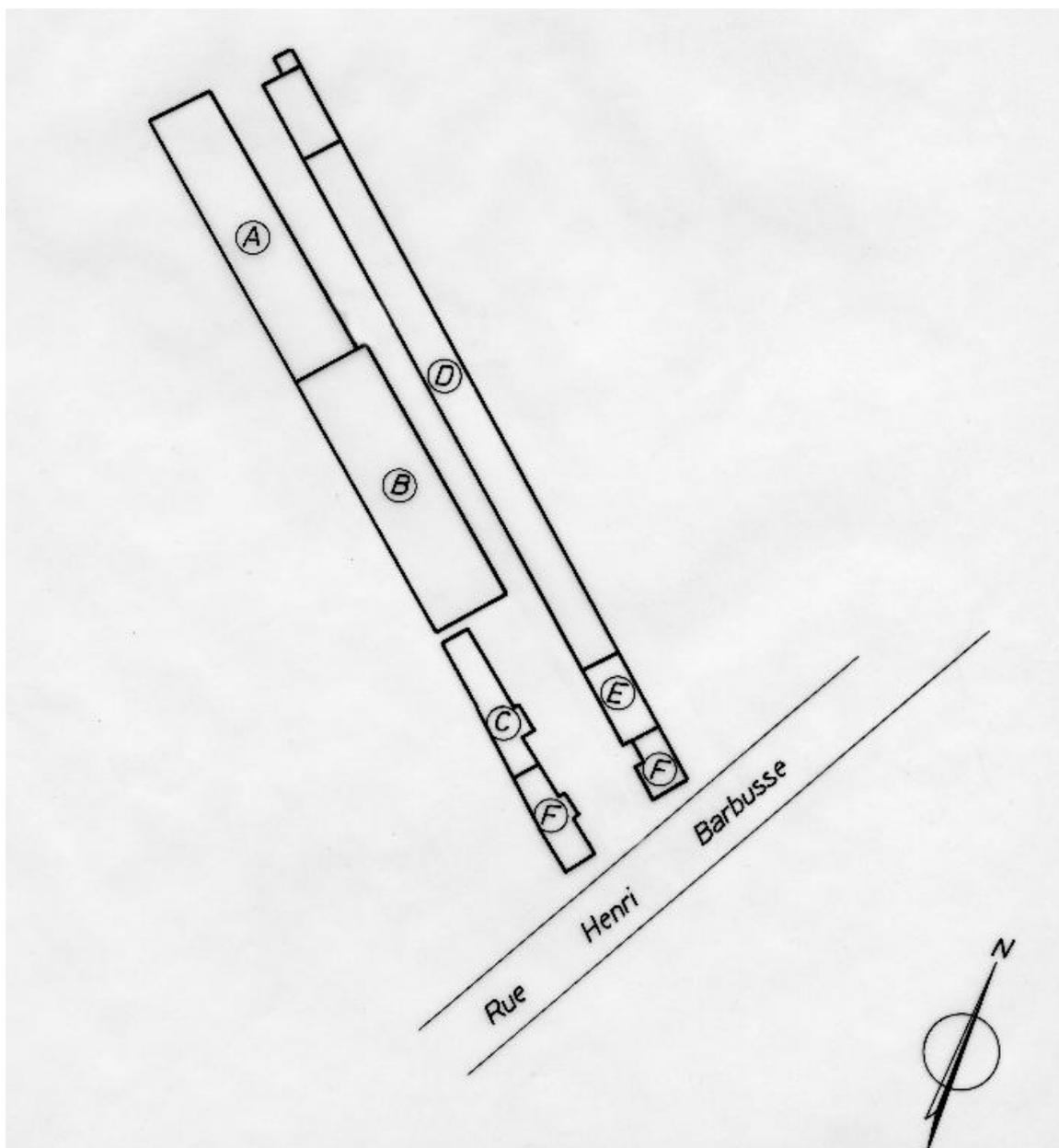
Schéma de situation : A. Fonderie, B. Atelier de fabrication, C. Cantines, écuries, D. Ateliers et magasins, E. Bureau, F. Logements.
