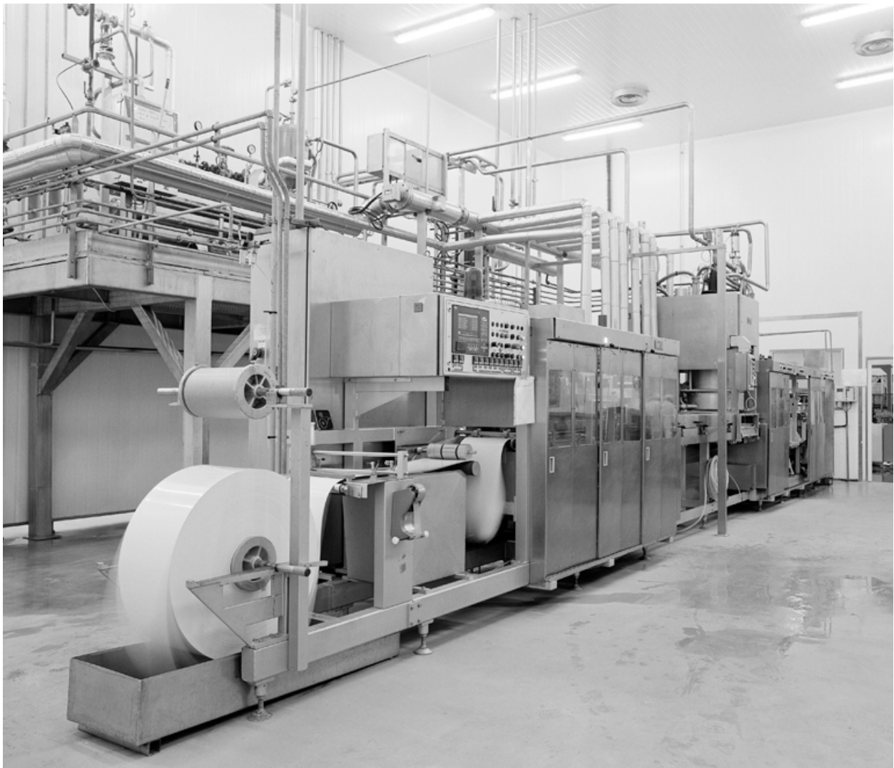
Conditionnement de la compote de pommes : vue d'ensemble de la ligne de thermoformage.
