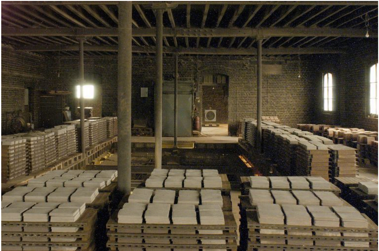
Vue intérieure de l'atelier de séchage des carrelages, au premier étage.
