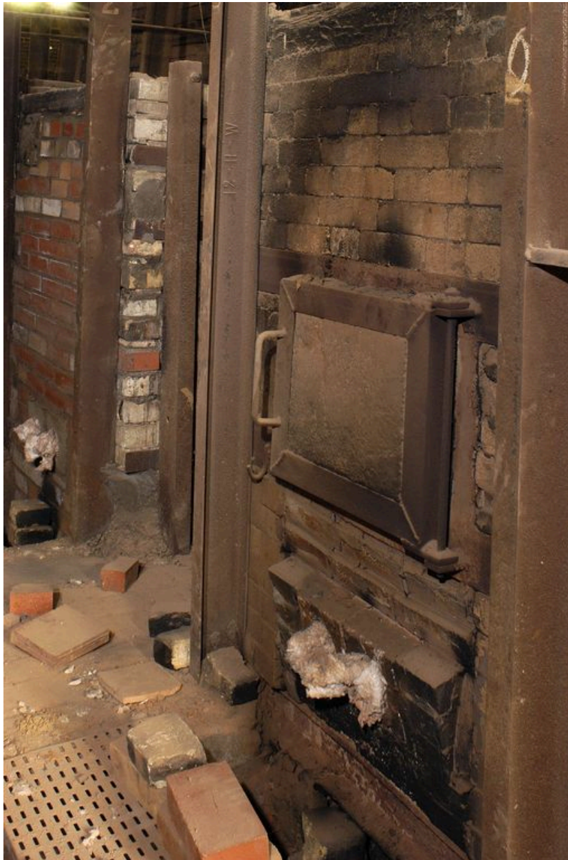
Détail d'un alandier du four de cuisson, dit four 3.
