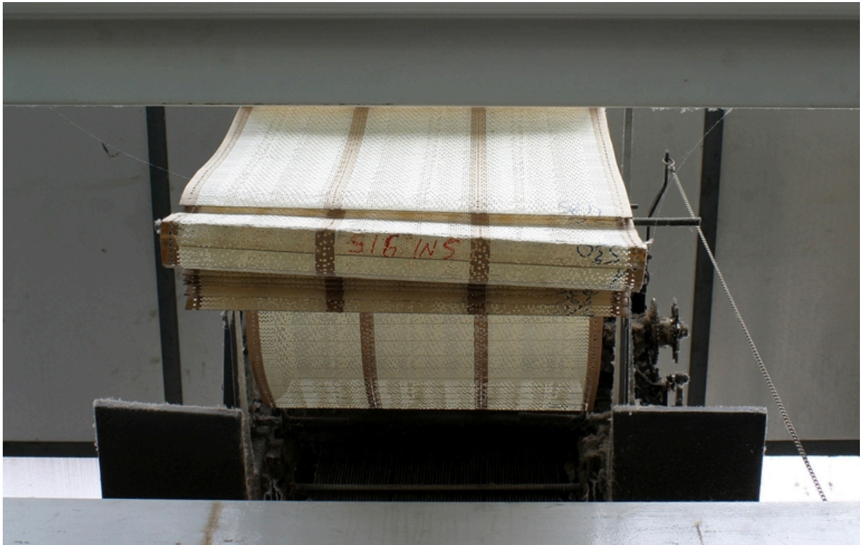
Carton continu de la mécanique Jacquard, vu de dessous.
