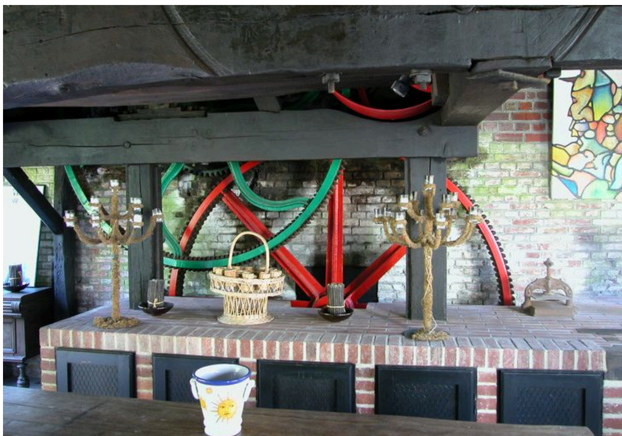
Le mécanisme principal de transmission de la force hydraulique.
