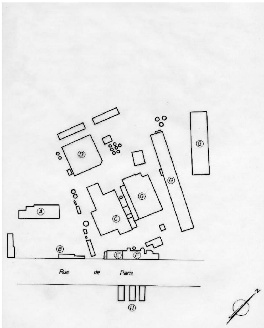
Schéma de situation : A. Logement patronal et atelier de fabrication (huilerie) avant 1898, B. Dépendances (avant 1898), C. Ateliers de fabrication et chaufferie (vers 1902 reconstruits après 1914 et 1940), D. Atelier de fabrication (1902), E. Entrepôts (vers 1948), F. Bureaux, G. Magasins et
