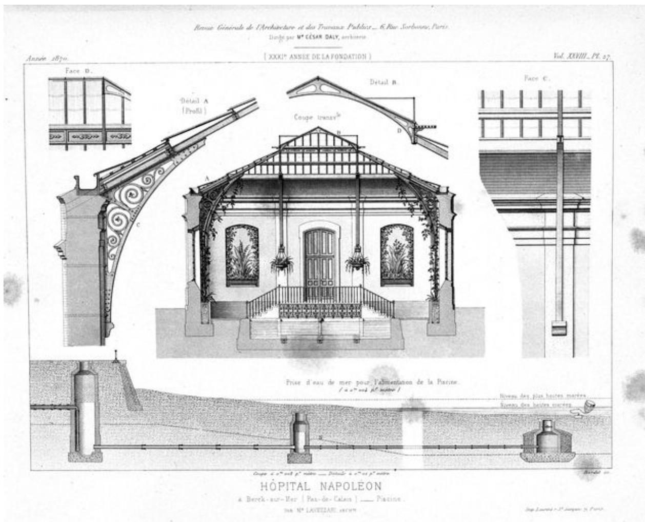
Piscine d'eau de mer couverte, coupe transversale, détails de la structure métallique du
