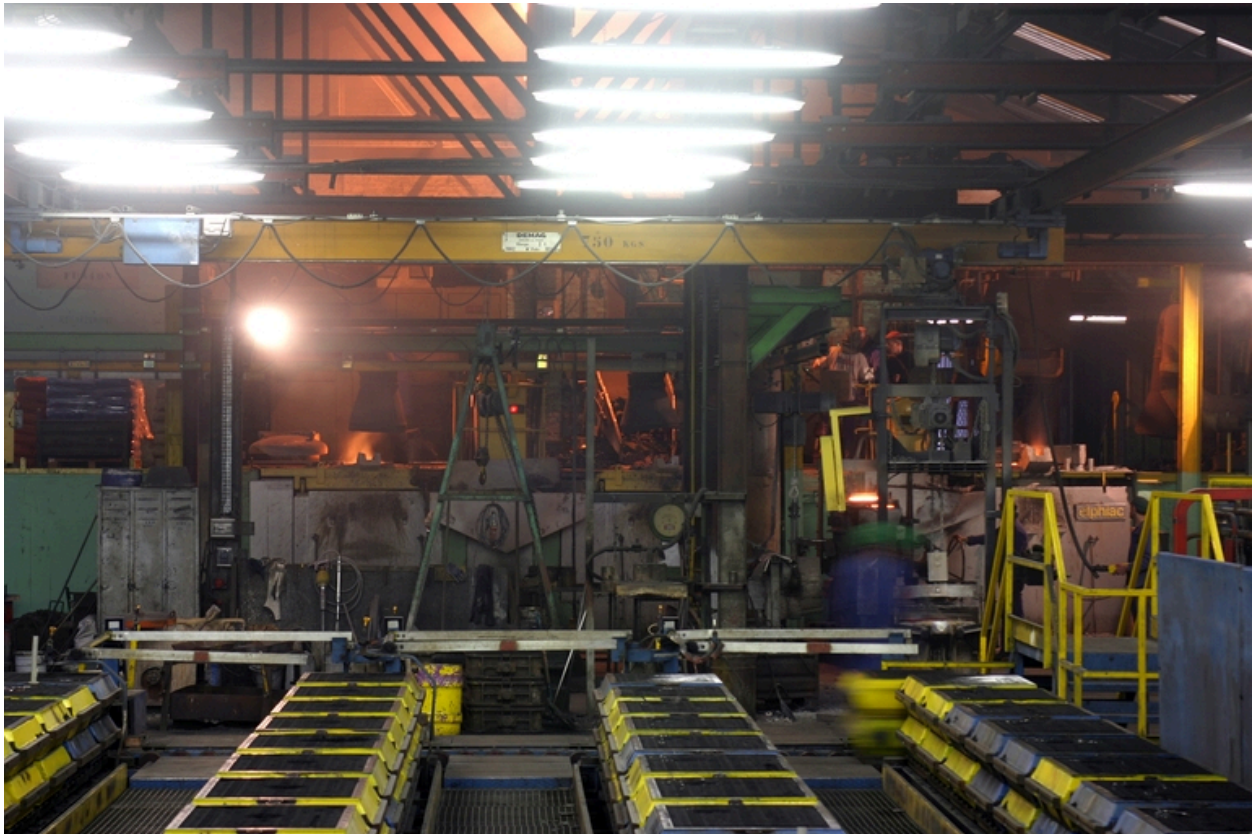
Chantier de moulage (premier plan) et fours de fusion (arrière-plan).
