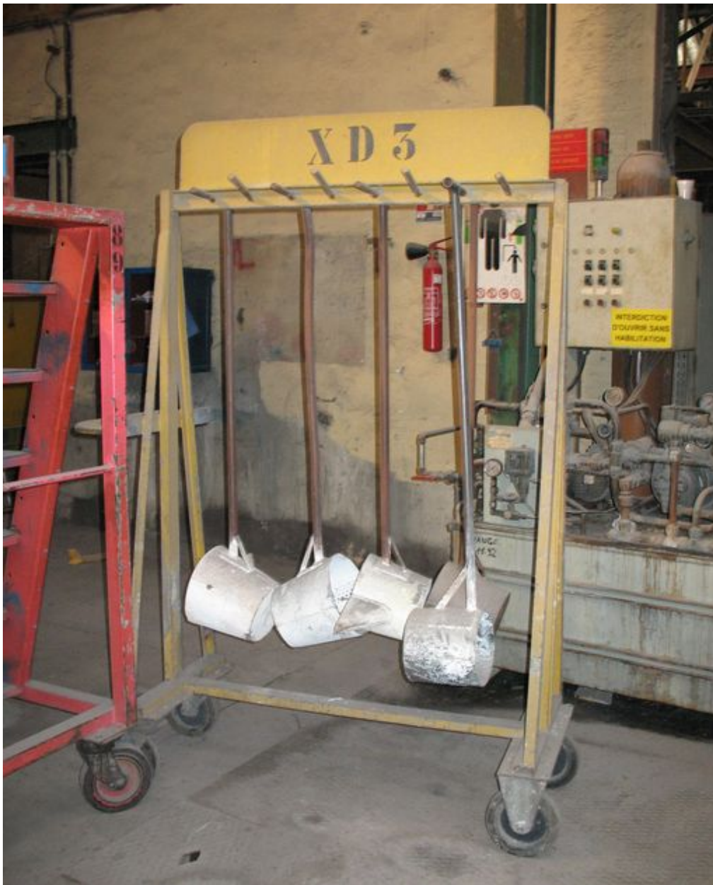
Louches utilisées pour les fours manuels.
