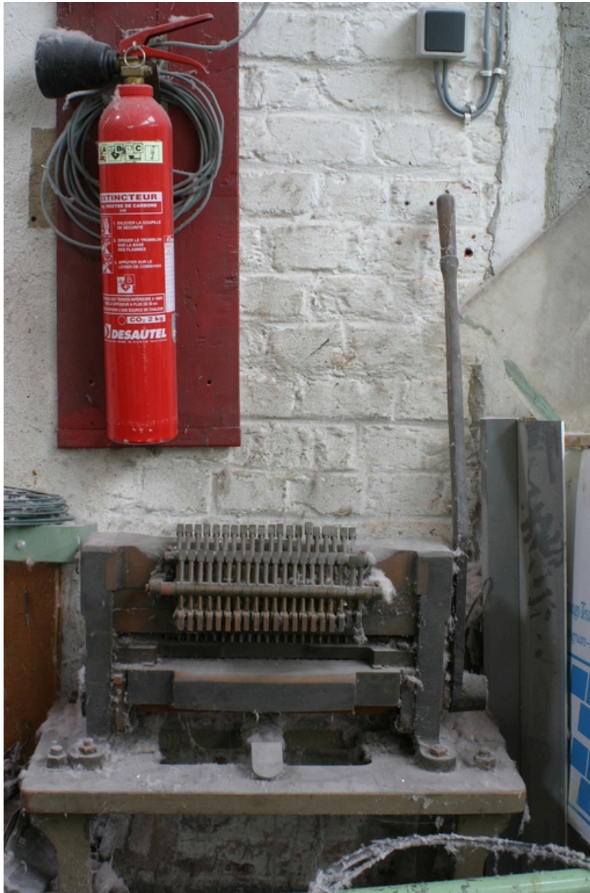
Ancienne machine à perforer les cartons des mécaniques Jacquard (constructeur : Lehembre & Cie - Roubaix).
