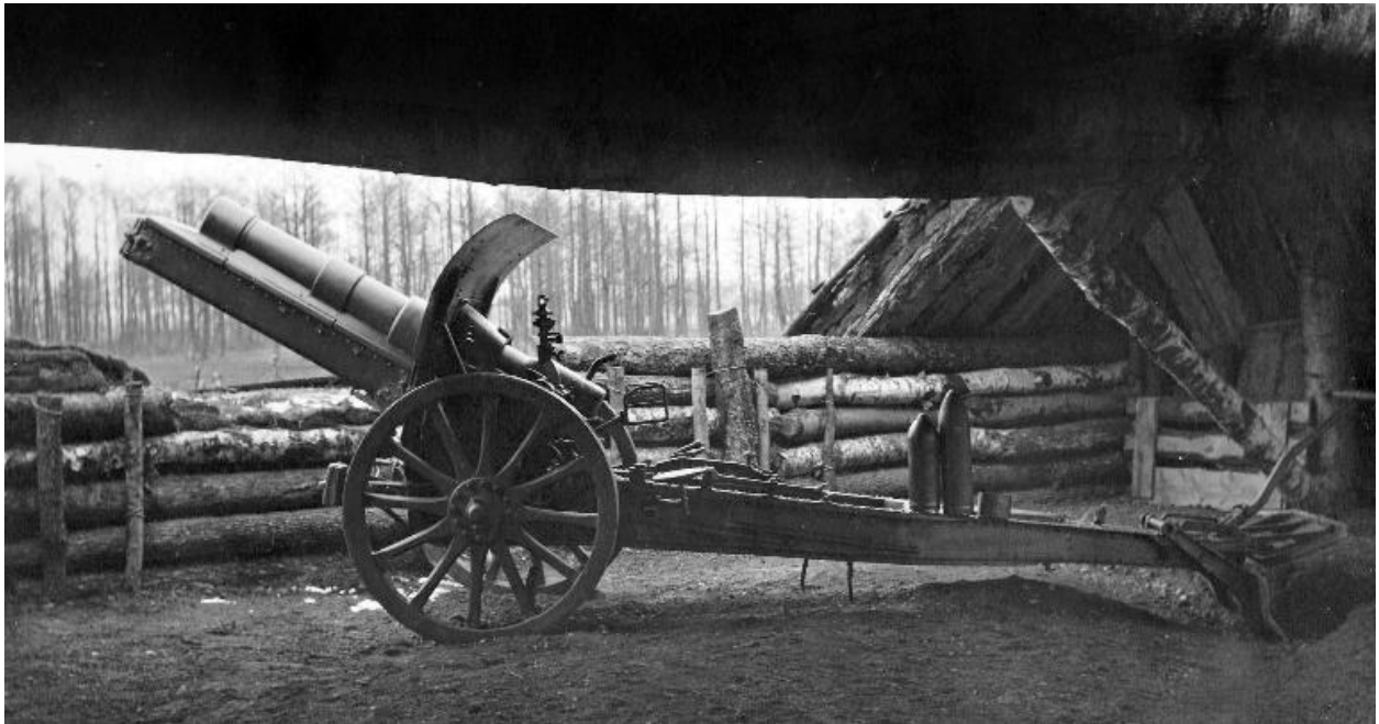
Canon Krupp de 150 mm du type de ceux accueillis dans ces deux postes d'artillerie (Archives privées)
