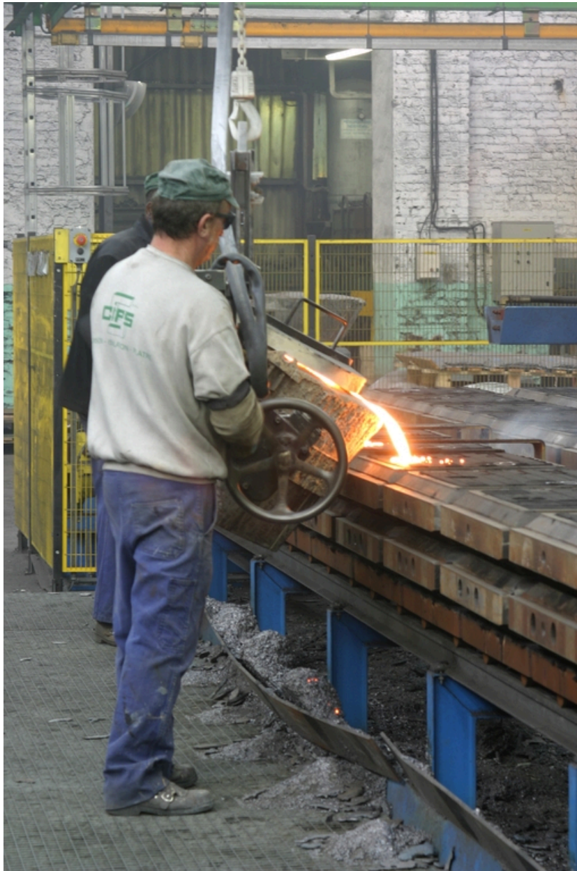
Coulée de fonte dans un moule du petit chantier de moulage.
