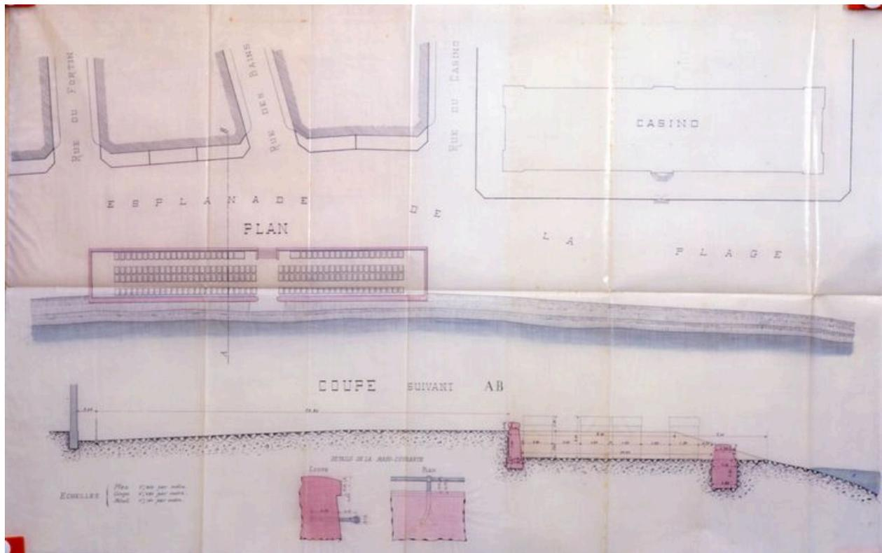
Projet (non réalisé) de construction d'une terrasse destinée à recevoir les cabines de l'établissement de bains froids, par E. Boeuf, architecte, 1894 (AD Somme ; 99 O 2594).
