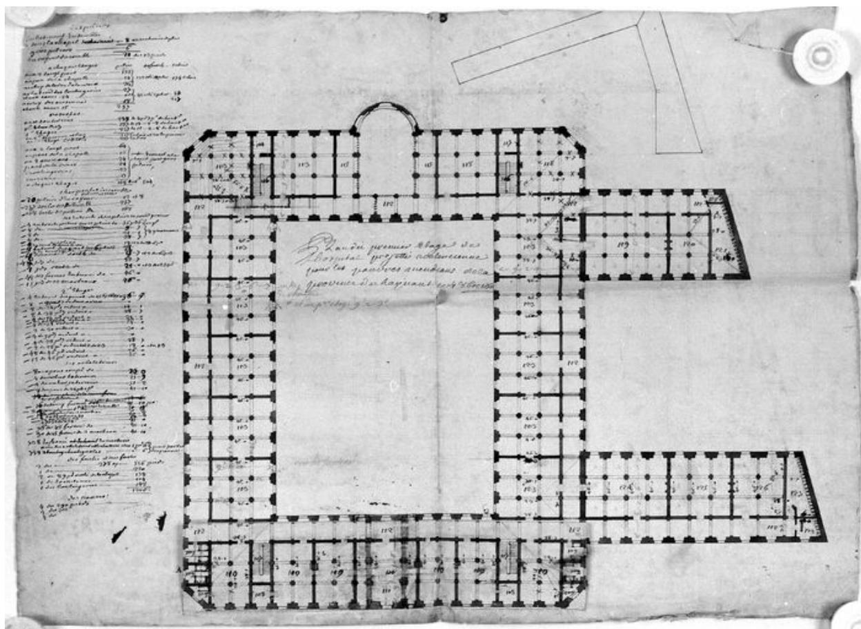
Projet de construction, 1er étage, plan de distribution générale, non signé, daté du 4 octobre 1750 (AD Nord ; C 5802) : vue générale avec la retombe montrant le plan de l'étage entresolé du bâtiment, fermant la cour d'honneur sur l'avant, repliée.
