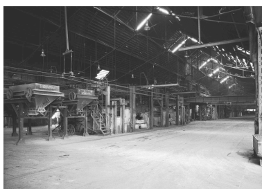
La halle à pots : vue générale intérieure et au premier plan à gauche, les trémies conservant la composition du verre. Phot. Philippe Caudroit IVR31_19795900010X
