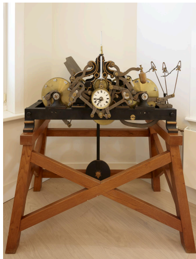
Ancien mécanisme de l'horloge de l'église, aujourd'hui conservé à la mairie. Phot. Delphine Volto-Jourdan IVR32_20235900691NUCA
