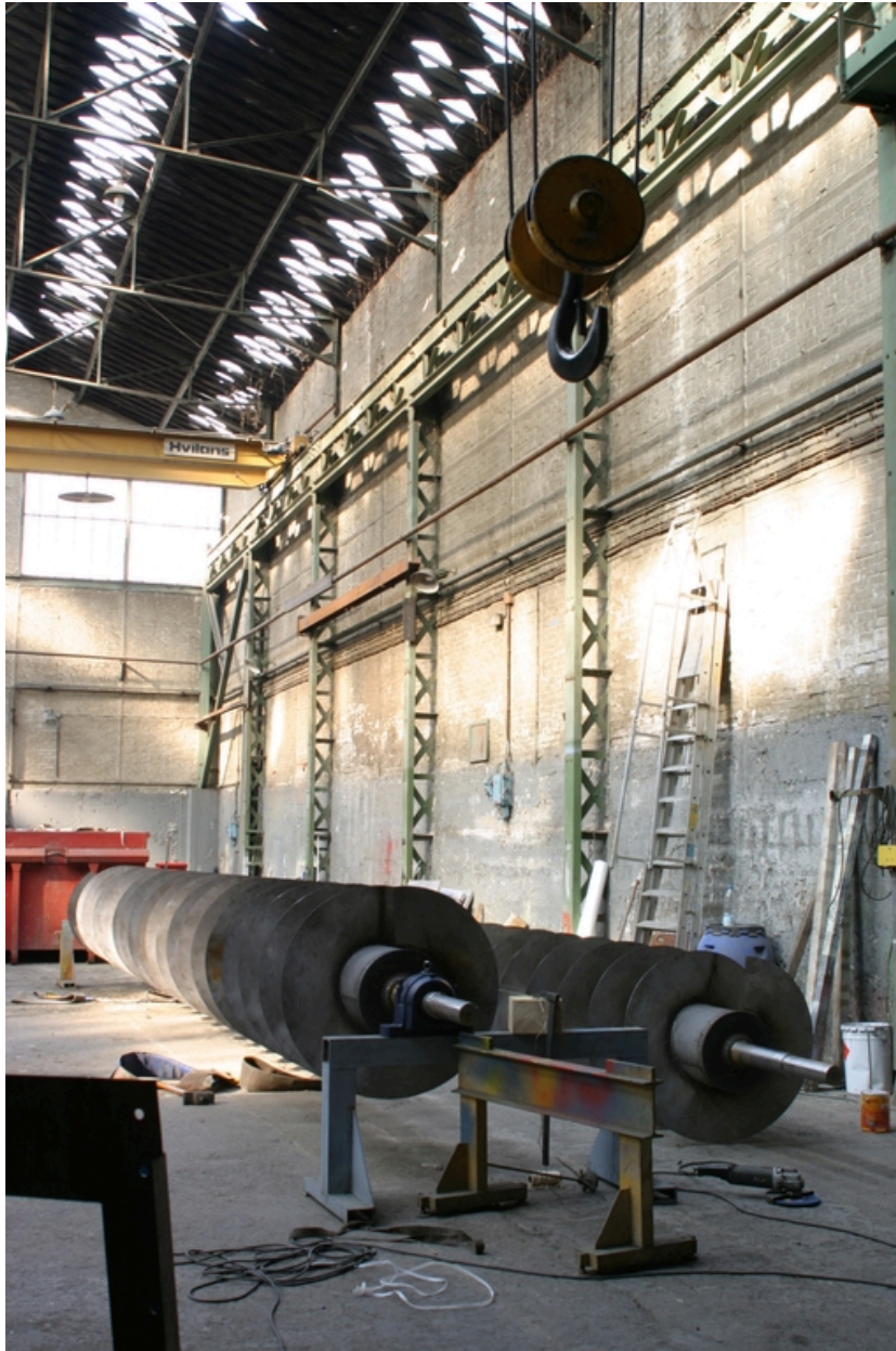
Intérieur du grand hall : au premier plan, montage de vis d'Archimède.
