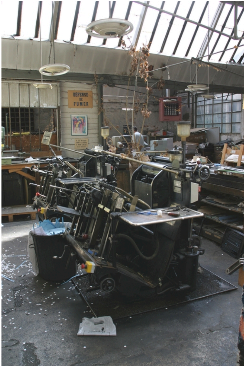
Atelier couvert de sheds : deux presses à platine Heidelberg.
