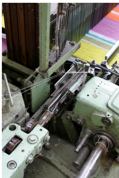
Lance d'entrée au repos : la foule est refermée, les deux fils de trame sont encore solidaires des deux dernières duites réalisées. Phot. Frédéric Pillet IVR22_20040201107NUCA
