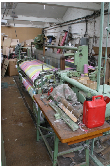
L'avant de la machine à tisser : le tissu passe sur le rouleau d'appel avant d'être enroulé sur le rouleau toilier. Phot. Frédéric Pillet IVR22_20040201102NUCA
