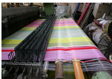
Les fils de chaîne, orientés par le porte-fils (cylindre à droite) et traversés par les baguettes d'encroix, sont chevauchés par les casse-chaînes à lamelles (au centre) avant de passer dans les oeillets des lisses (à gauche).
