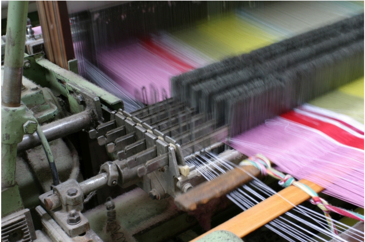
Casses-chaînes et lames de lisses en mouvement.
