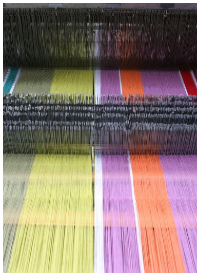
Casse-chaînes et lames de lisses à l'arrêt. Phot. Frédéric Pillet IVR22_20040201101NUCA
