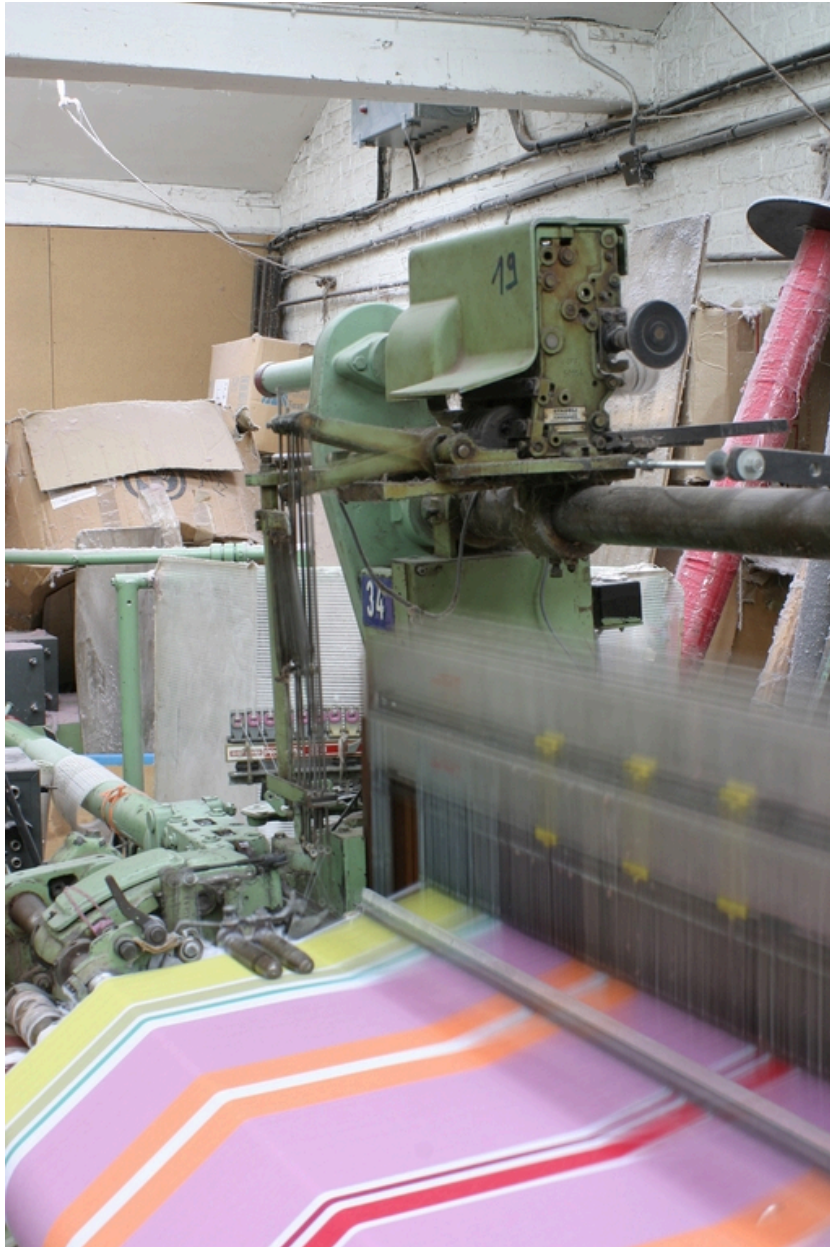
Vue générale de l'avant de la machine à tisser : le sélecteur de fil de trame, au-dessus des lames de lisses en mouvement.
