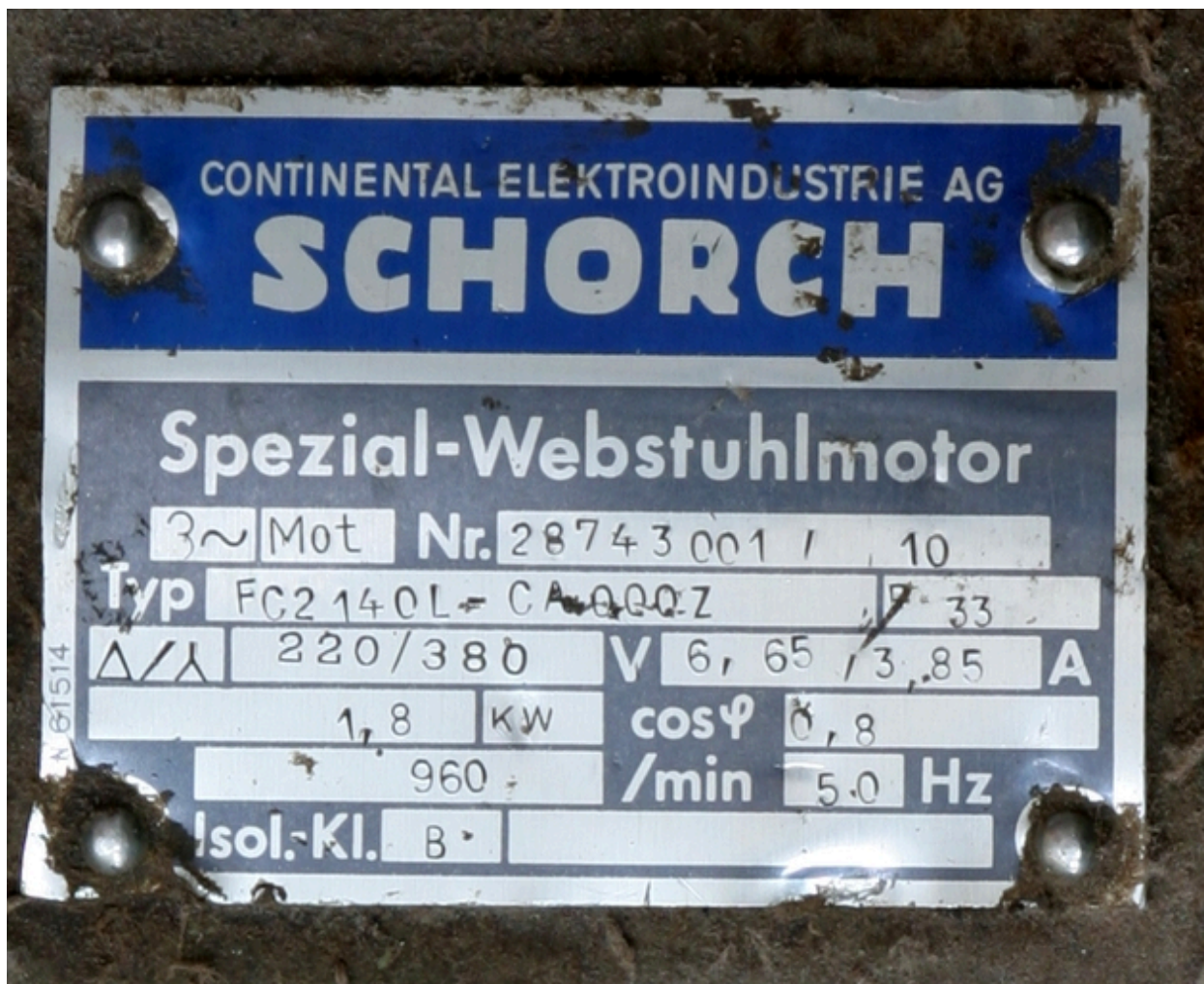
Plaque signalétique du moteur électrique de la machine à tisser.
