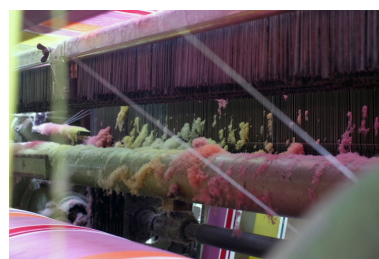
Les fils de chaîne, déroulés de l'ensouple (en bas à gauche), orientés par le porte-fils, sont chevauchés par les casse-chaînes à lamelle (au centre), avant de passer dans les lisses (à droite). Phot. Frédéric Pillet IVR22_20040201094NUCA
