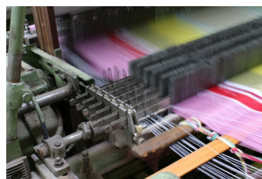
Casses-chaînes et lames de lisses en mouvement.
