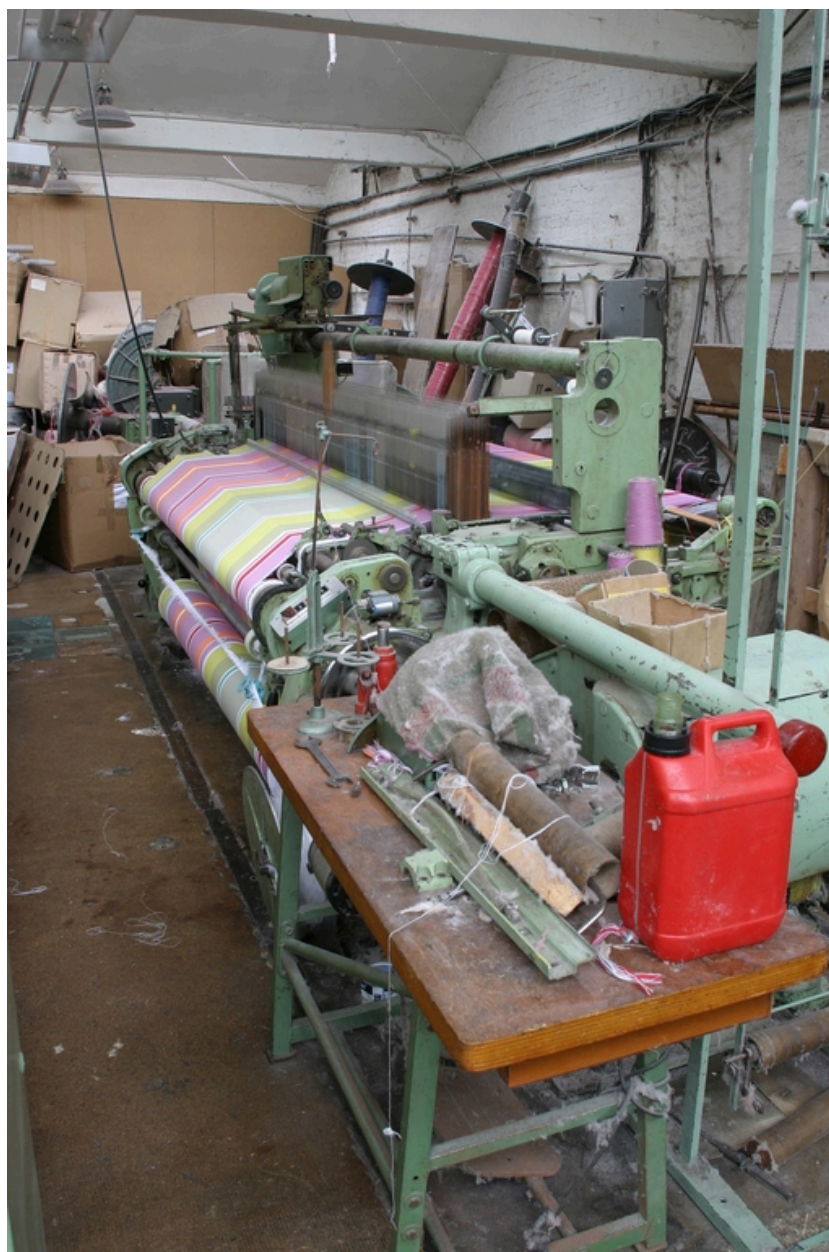
L'avant de la machine à tisser : le tissu passe sur le rouleau d'appel avant d'être enroulé sur le rouleau toilier.
