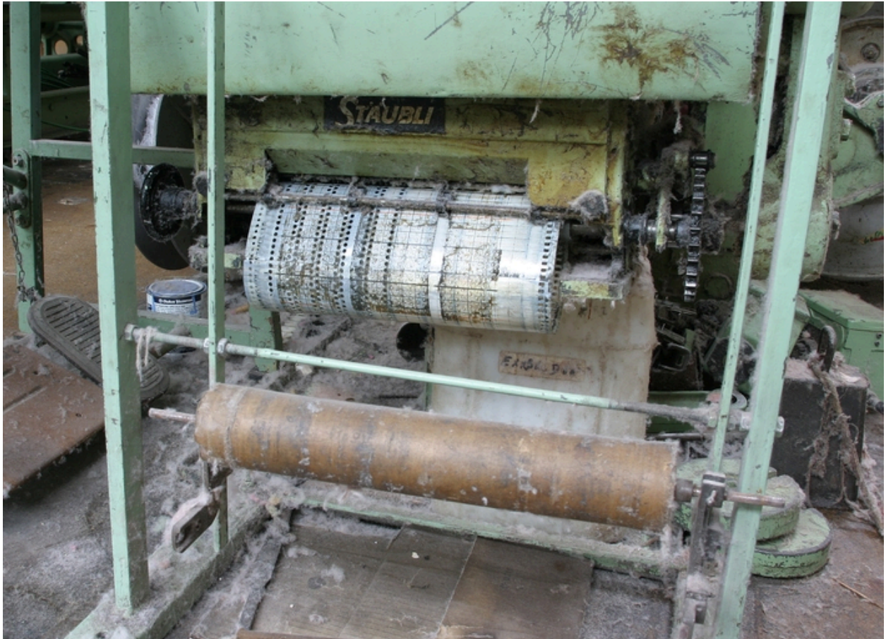
Ratière Stäubli destinée à la mise en mouvement des lames de lisses.
