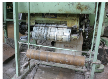
Ratière Stäubli destinée à la mise en mouvement des lames de lisses.
