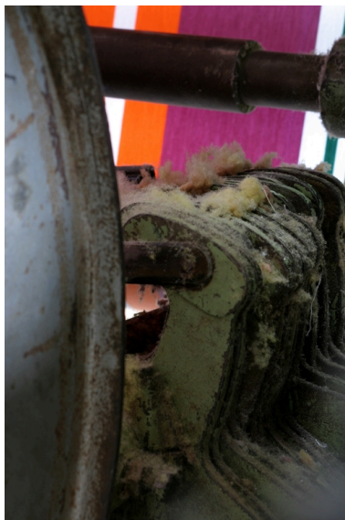
Mécanisme de la ratière pour la mise en mouvement des lames (ou cadres) de lisses.
