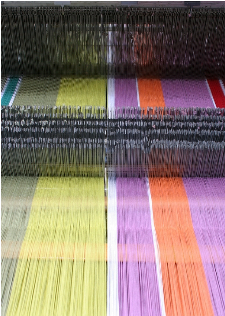
Casse-chaînes et lames de lisses à l'arrêt.
