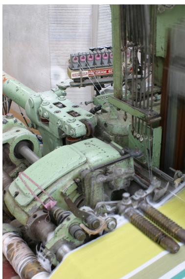
Vue générale des mécanismes de la lance d'entrée. Phot. Frédéric Pillet IVR22_20040201108NUCA
