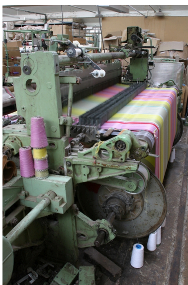
Ensemble déroulant les fils de chaîne sur le rouleau porte-fils, en direction des lisses.
