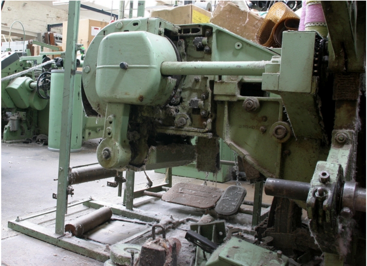
Ratière (mécanisme d'armure) Stäubli de la machine à tisser.
