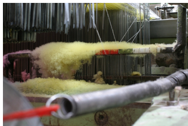
Casse-chaînes à lamelles (en haut, à gauche) et lisses, vus de dessous.
