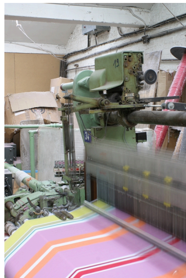
Vue générale de l'avant de la machine à tisser : le sélecteur de fil de trame, au-dessus des lames de lisses en mouvement. Phot. Frédéric Pillet IVR22_20040201103NUCA
