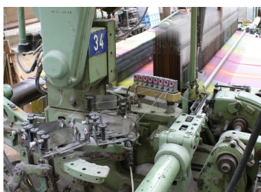
Les deux fils de trame sont conduits vers la lance d'entrée. A l'arrière-plan, la chaîne. De gauche à droite, les casse-chaînes, les lames et le peigne. Phot. Frédéric Pillet IVR22_20040201105NUCA
