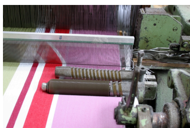
Les lisses (en haut), le peigne et la lance de sortie au repos (au centre), et deux carottes de templets. Phot. Frédéric Pillet IVR22_20040201110NUCA
