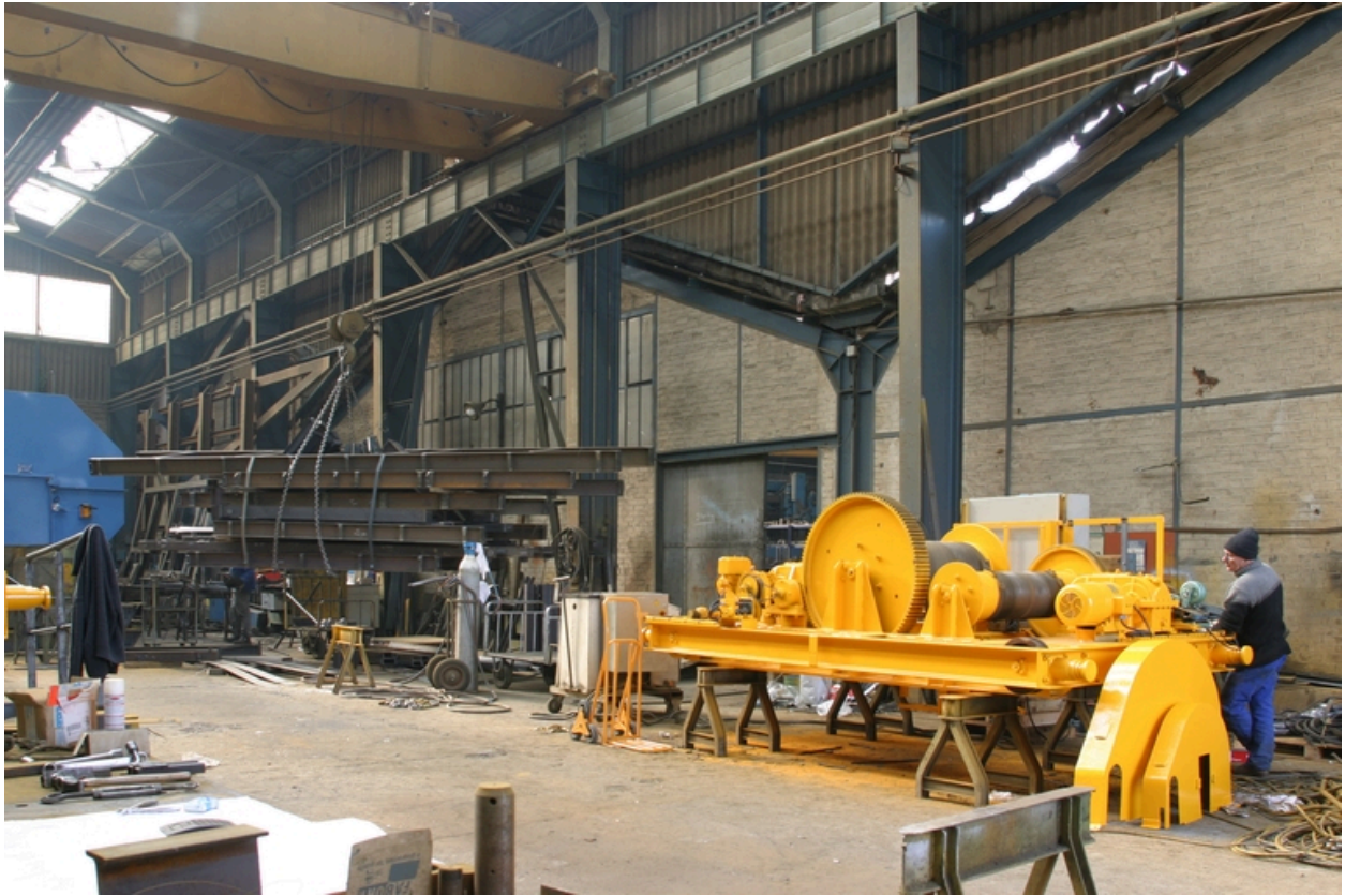
Atelier : assemblage d'un treuil.
