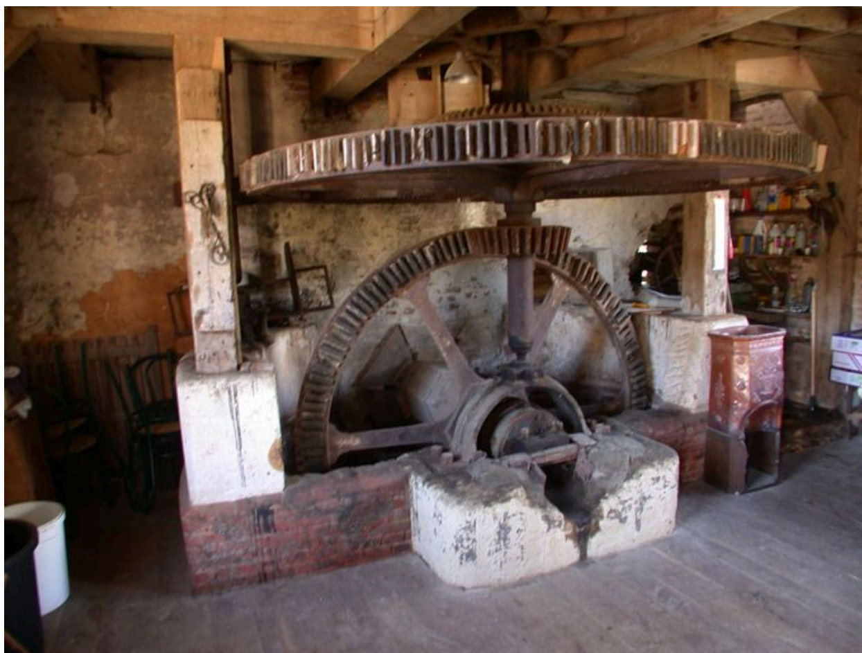
Intérieur du rez-de-chaussée, vue du système principal de transmission par engrenages.
