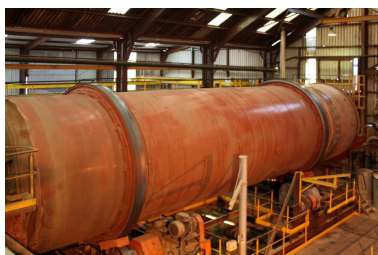
Cylindre d'épierreage et de lavage des betteraves. Phot. Bertrand Fournier IVR22_20148005139NUC2A
