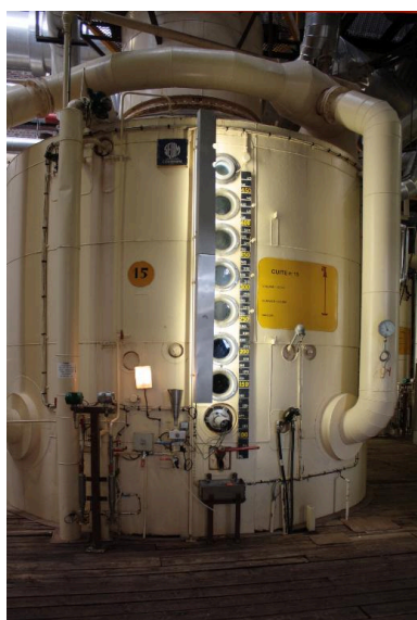
Cuite de cristallisation. Phot. Bertrand Fournier IVR22_20148005143NUC2A
