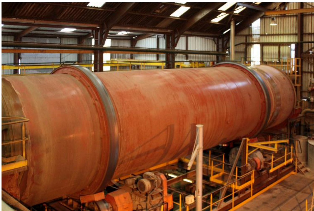
Cylindre d'épierreage et de lavage des betteraves.
