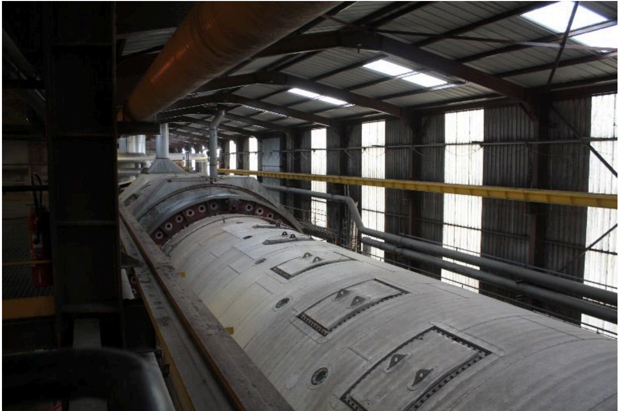
Cylindre de diffusion de type RT.
