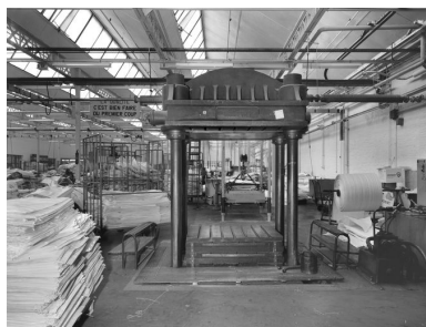
Intérieur de l'atelier de fabrication, abritant une presse hydraulique de 1899, état de 1988. Phot. Thierry Lefébure IVR22_19888000507V
