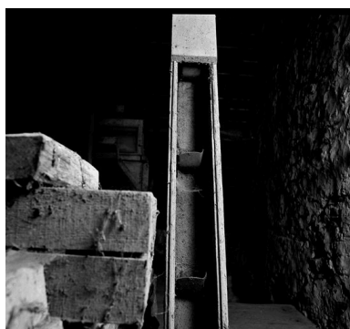
Elévateur à godets. Phot. Olivier Coquelle IVR22_19946000897X
