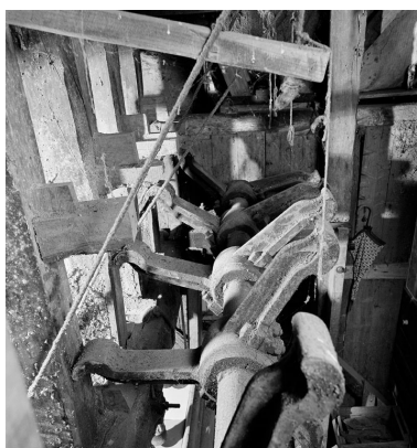
Détail des lèves des battors. Phot. Olivier Coquelle IVR22_19946000898X
