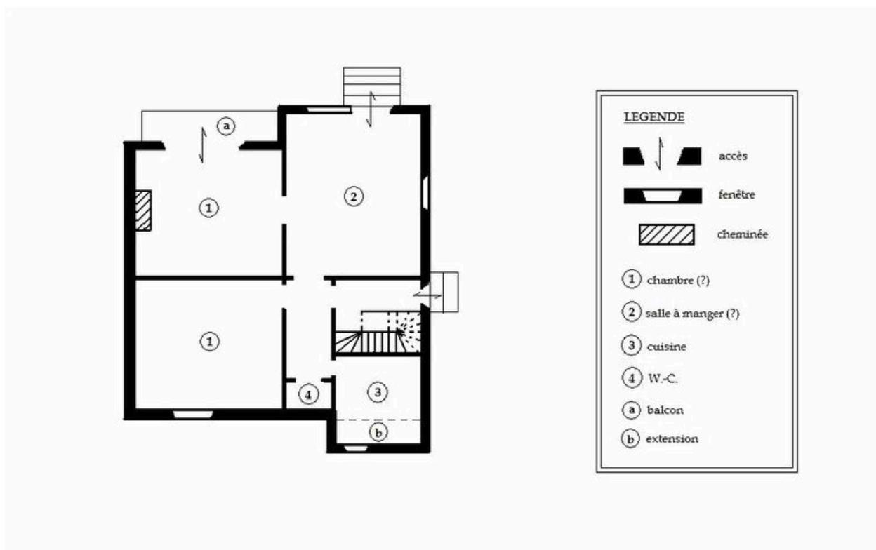
Relevé schématique du rez-de-chaussée.
