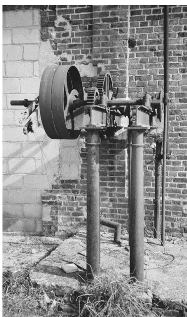
Pompe, détail. Phot. Benoît Dufournier IVR22_19936001674Z
