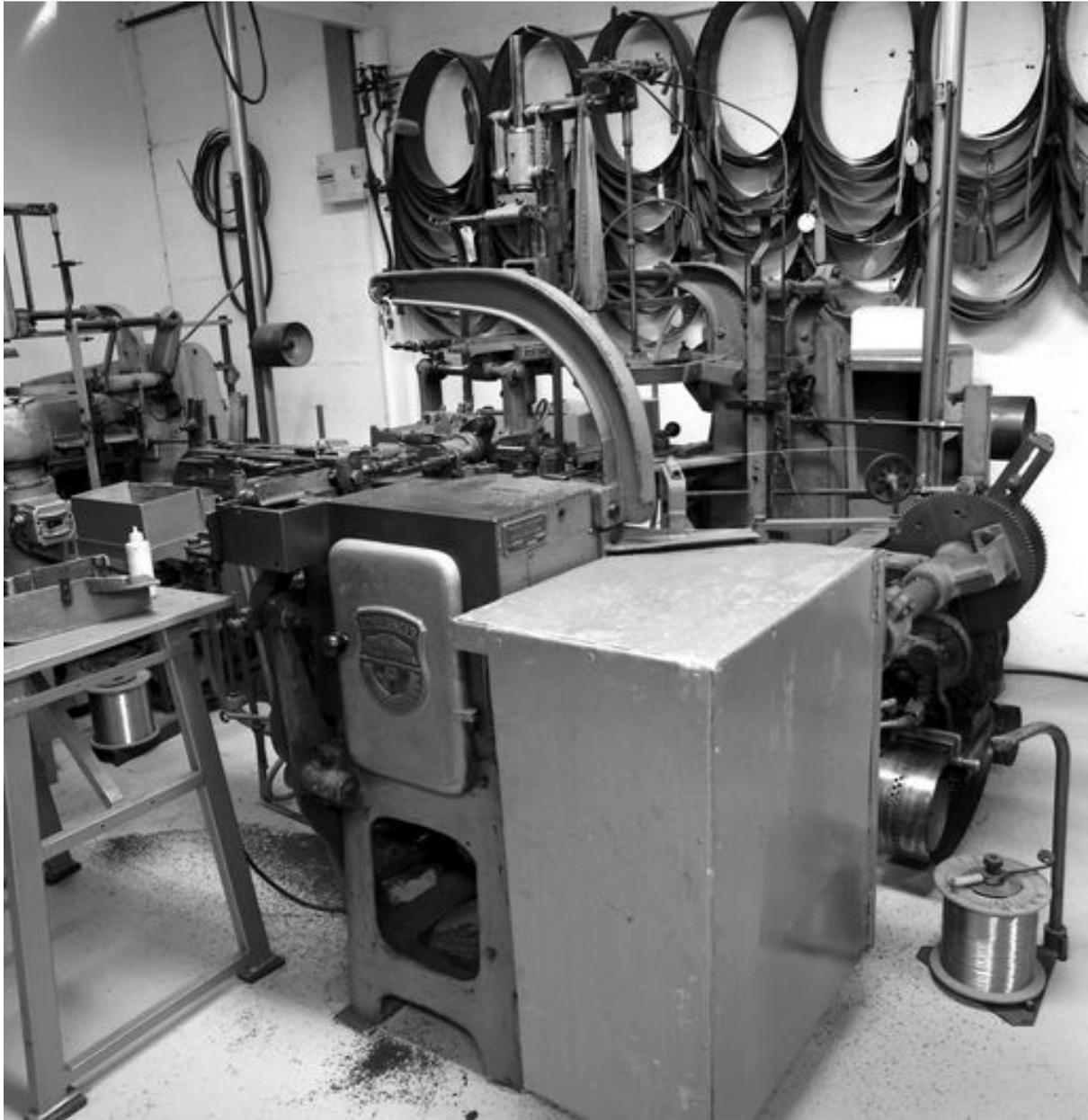
Machine à percer et à monter les brosses à guidage par bande, datant de 1964 et de marque Schlesinger.
