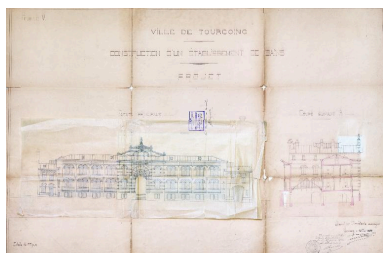
Projet de 1899 : façade et coupe montrant les bains publics, par l'architecte Dehaene (AC Tourcoing ; M1F3). Phot. Pierre Thibaut, Autr. Désiré Dehaene IVR32_20165900613NUCA
