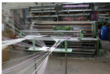
Les fils sont dirigés depuis les casse-fils vers le peigne enverjeur. A l'arrière-plan, l'ourdissoir. Phot. Frédéric Pillet IVR22_20040201089NUCA
