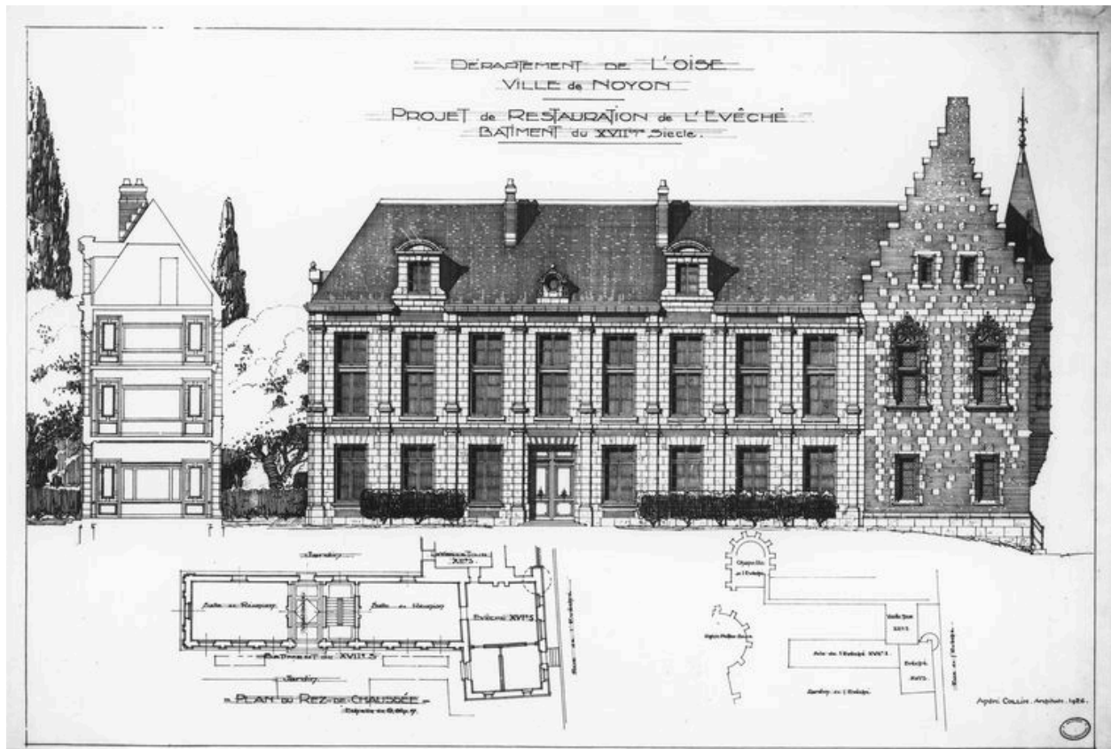
Plan, coupe et élévation de l'aile du 16e siècle. Projet de restauration par Collin, 1926.
