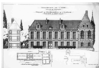
Plan, coupe et élévation de l'aile du 16e siècle. Projet de restauration par Collin, 1926. Repro. Monnehay- Vulliet Marie-Laure IVR22_20096000465NUCA
