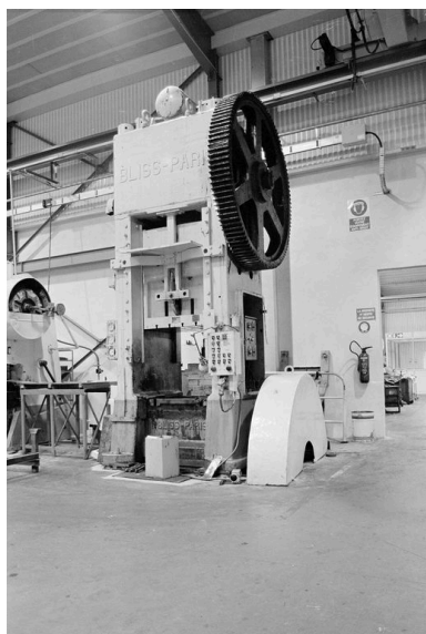
CRISOLLES. Usine de construction mécanique Lelong puis usine de roulements M.P.R. : presse mécanique du constructeur Bliss. Phot. Benoît Dufournier IVR22_19936001656Z
