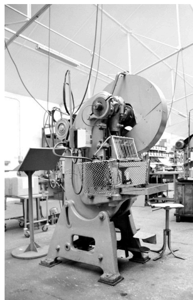
CRISOLLES. Usine de construction mécanique Lelong puis usine de roulements M.P.R. : presse d'emboutissage et de rivetage. Phot. Bertrand Fournier IVR22_20006000429Z
