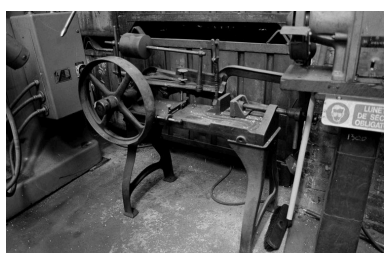
CRISOLLES. Usine de construction mécanique Lelong puis usine de roulements M.P.R. : machine destinée à scier les rondins de fer (?) Phot. Benoît Dufournier IVR22_19936001646Z
