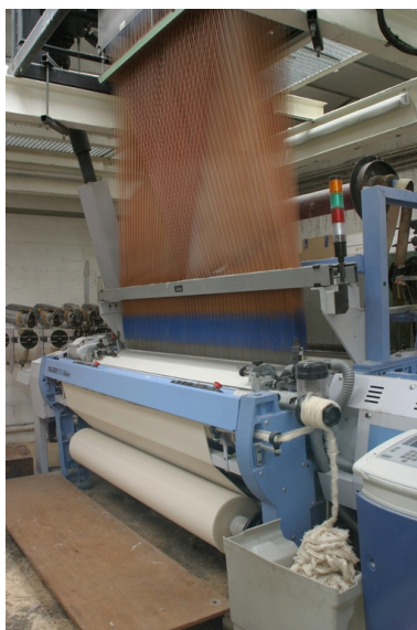
Machine à tisser à pinces à commande numérique Sulzer Textil G3600. Phot. Frédéric Pillet IVR22_20040201073NUCA
