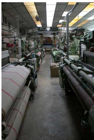
Huit machines à tisser à pinces Dornier des années 1971-73. Au fond, la machine à tisser Sulzer Textil G3600. Phot. Frédéric Pillet IVR22_20040201075NUCA
