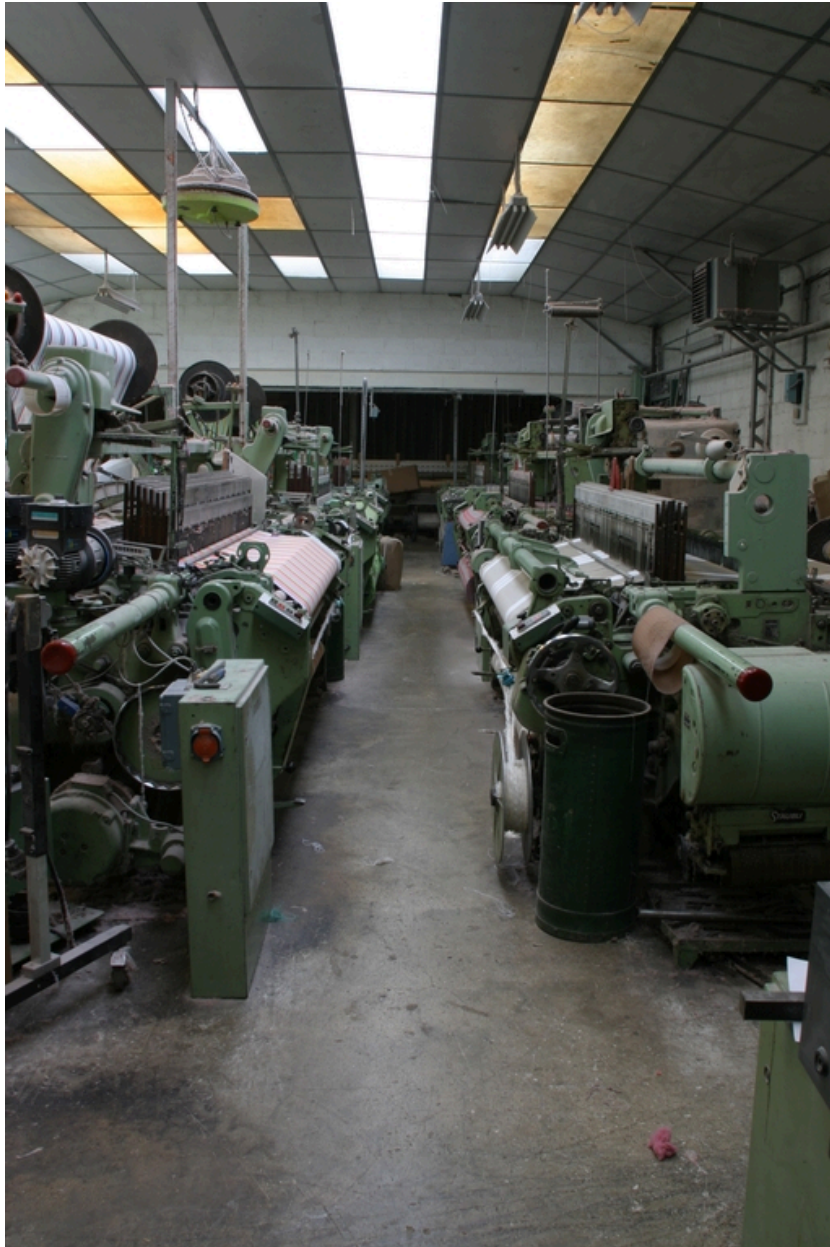
Atelier de tissage de 1972 : 6 machines à tisser à pinces Dornier construites entre 1971 et 1973.
