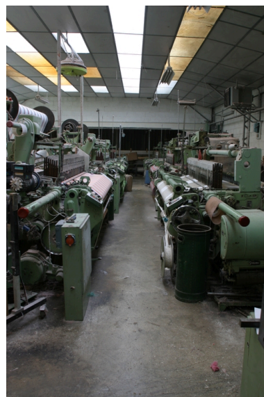
Atelier de tissage de 1972 : 6 machines à tisser à pinces Dornier construites entre 1971 et 1973. Phot. Frédéric Pillet IVR22_20040201074NUCA
