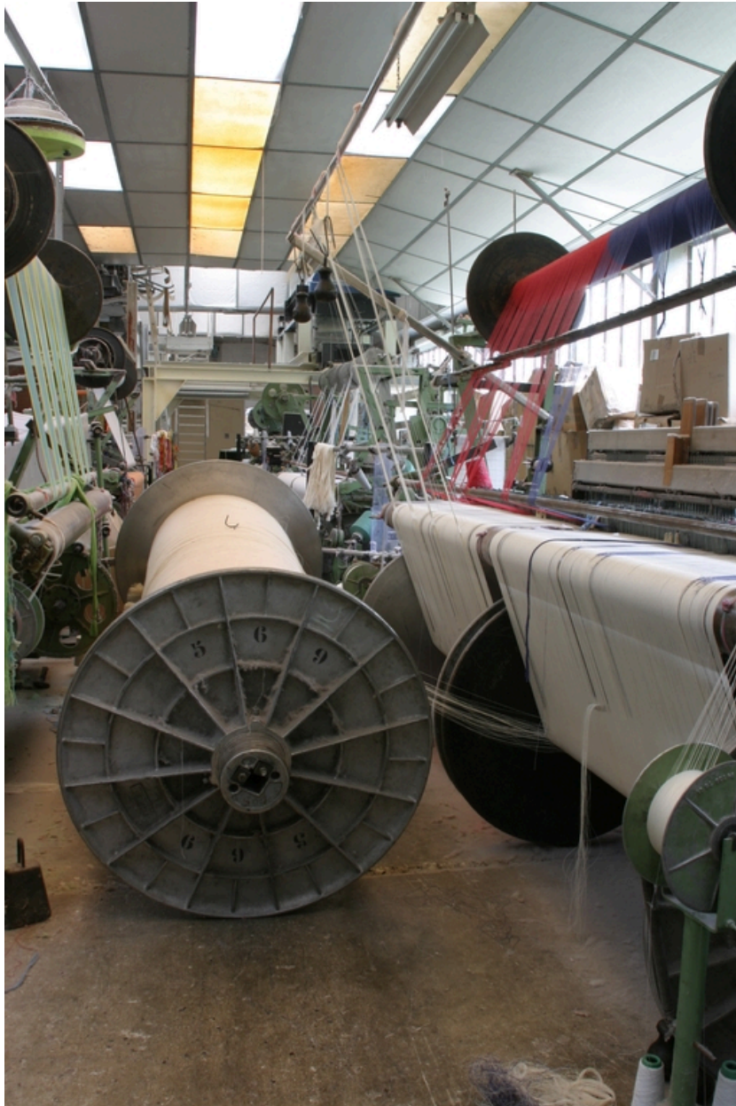
Ensouple (rouleau portant les fils de chaîne) en attente d'être posé sur une machine à tisser à deux ensouples (à droite).
