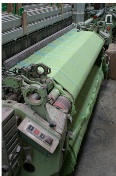
Machine à tisser à pinces Dornier montée avec deux ensouples : le tissu achevé s'enroule sur le rouleau toilier. Phot. Frédéric Pillet IVR22_20040201079NUCA
