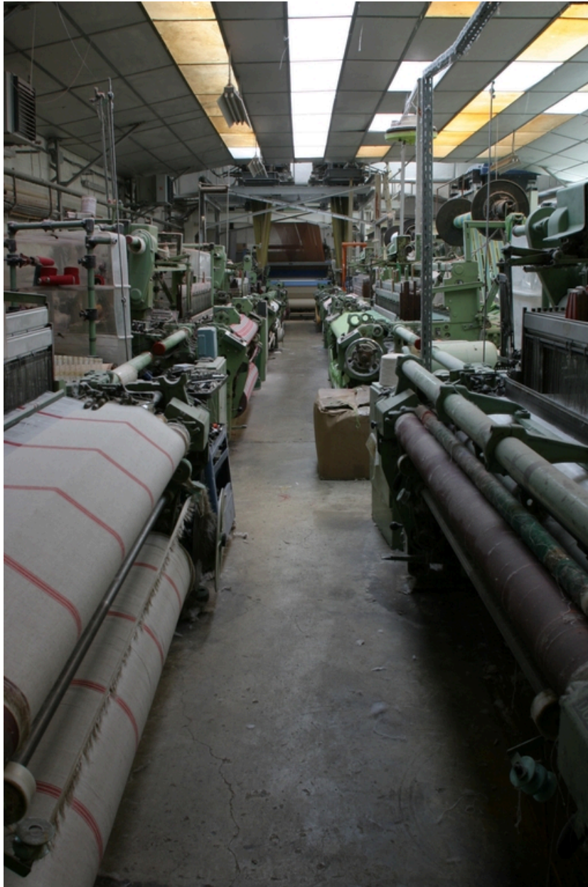
Huit machines à tisser à pinces Dornier des années 1971-73. Au fond, la machine à tisser Sulzer Textil G3600.
