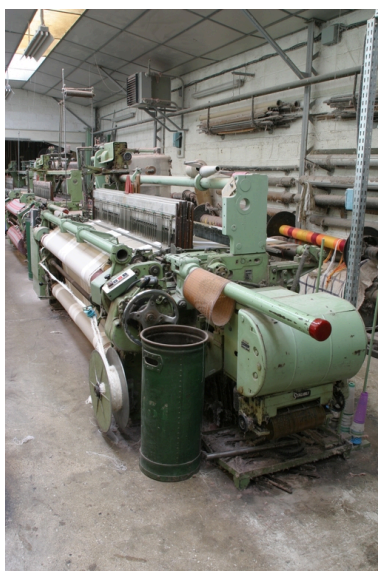
Machine à tisser à pinces Dornier n°7, construite en 1971. Phot. Frédéric Pillet IVR22_20040201076NUCA
