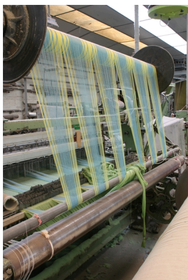
Machine à tisser à pinces montée avec deux ensouples (l'une est en cours d'installation). Phot. Frédéric Pillet IVR22_20040201078NUCA
