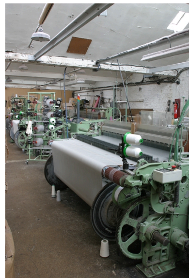
Machines à tisser à pinces dans les anciens ateliers de broderie de 1898. Phot. Frédéric Pillet IVR22_20040201068NUCA
