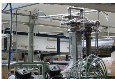
Colonne de fonte et mécanique Jacquard d'un métier à tisser hors service sous les sheds de l'atelier de broderie mécanique de 1898. Phot. Frédéric Pillet IVR22_20040201070NUCA
