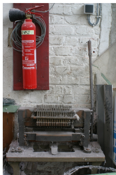
Ancienne machine à perforer les cartons des mécaniques Jacquard (constructeur : Lehembre & Cie - Roubaix). Phot. Frédéric Pillet IVR22_20040201080NUCA
