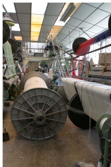
Ensouple (rouleau portant les fils de chaîne) en attente d'être posé sur une machine à tisser à deux ensouples (à droite). Phot. Frédéric Pillet IVR22_20040201077NUCA
