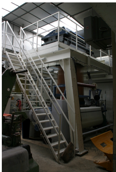
Machine à tisser à pinces à commande numérique Sulzer Textil G6300, surmontée de sa mécanique Jacquard. Phot. Frédéric Pillet IVR22_20040201072NUCA
