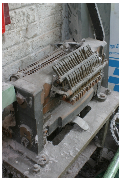
Ancienne machine à perforer les cartons des mécaniques Jacquard (constructeur : Lehembre & Cie - Roubaix). Phot. Frédéric Pillet IVR22_20040201081NUCA
