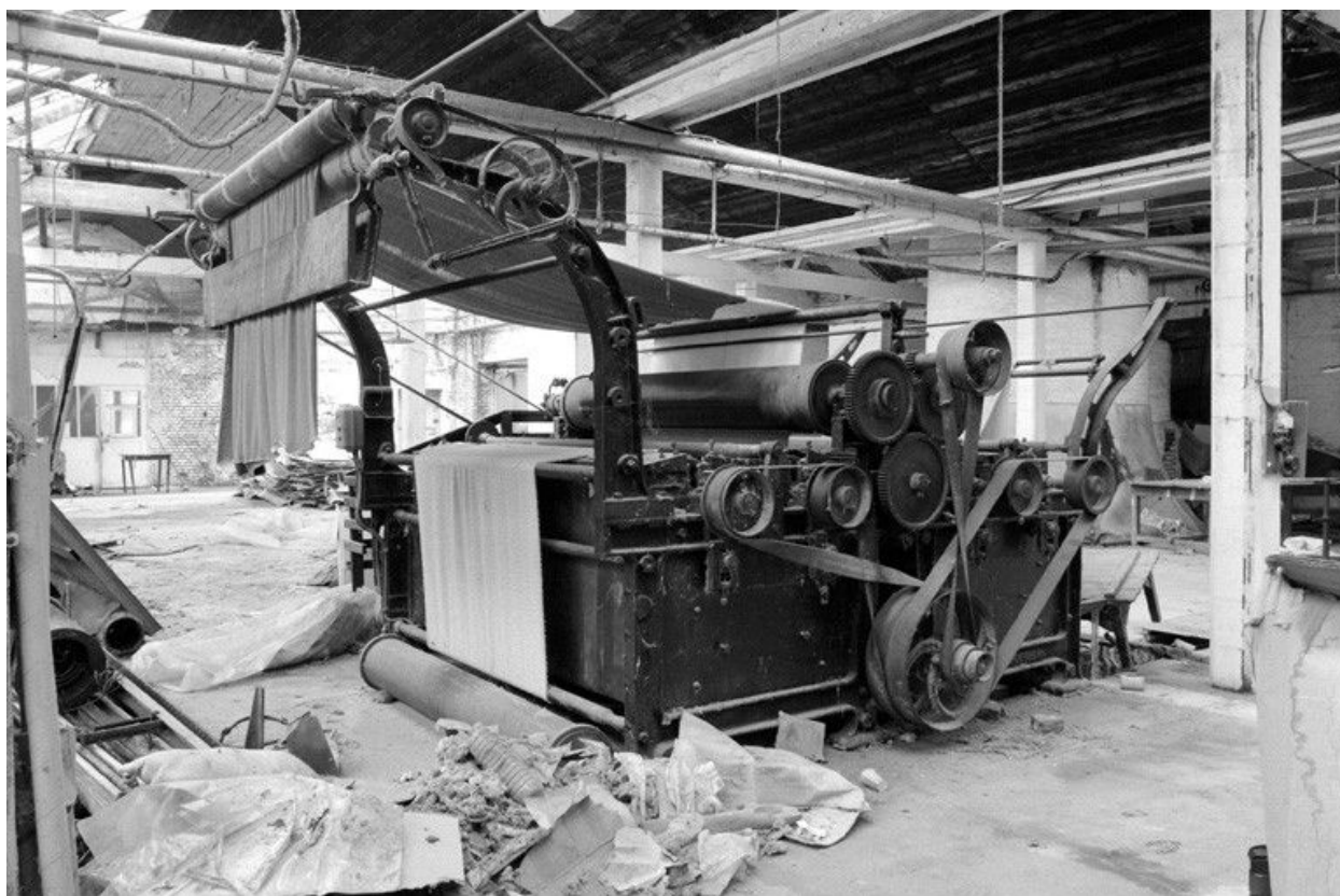
Vue intérieure de l'atelier et de la gratteuse-feutreuse (Gosselin père et fils constructeurs, Sedan, vers 1920-1925)
