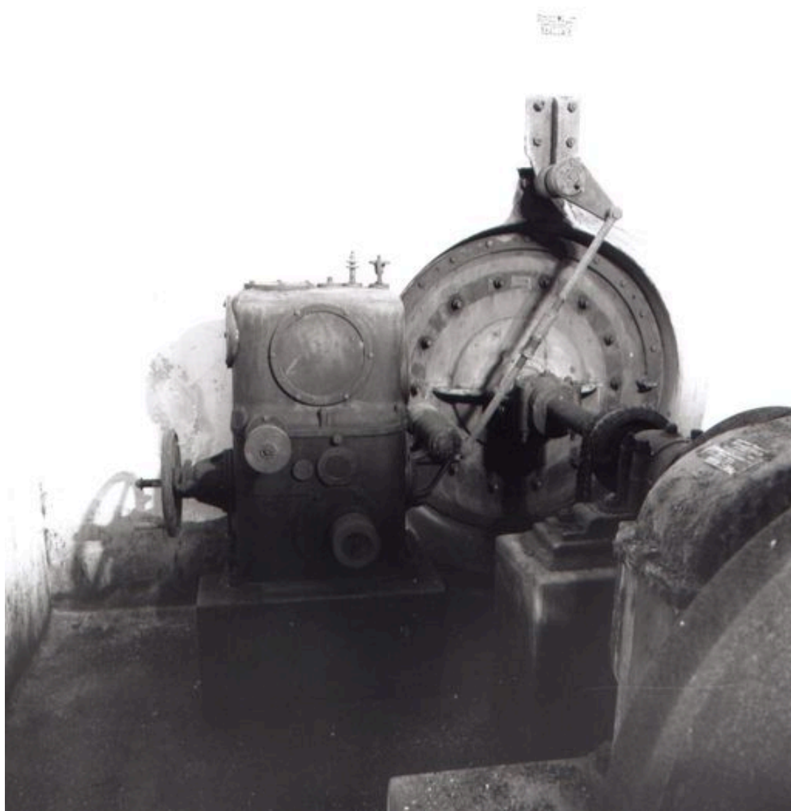
Détail de l'arbre de transmission horizontal et du régulateur.
