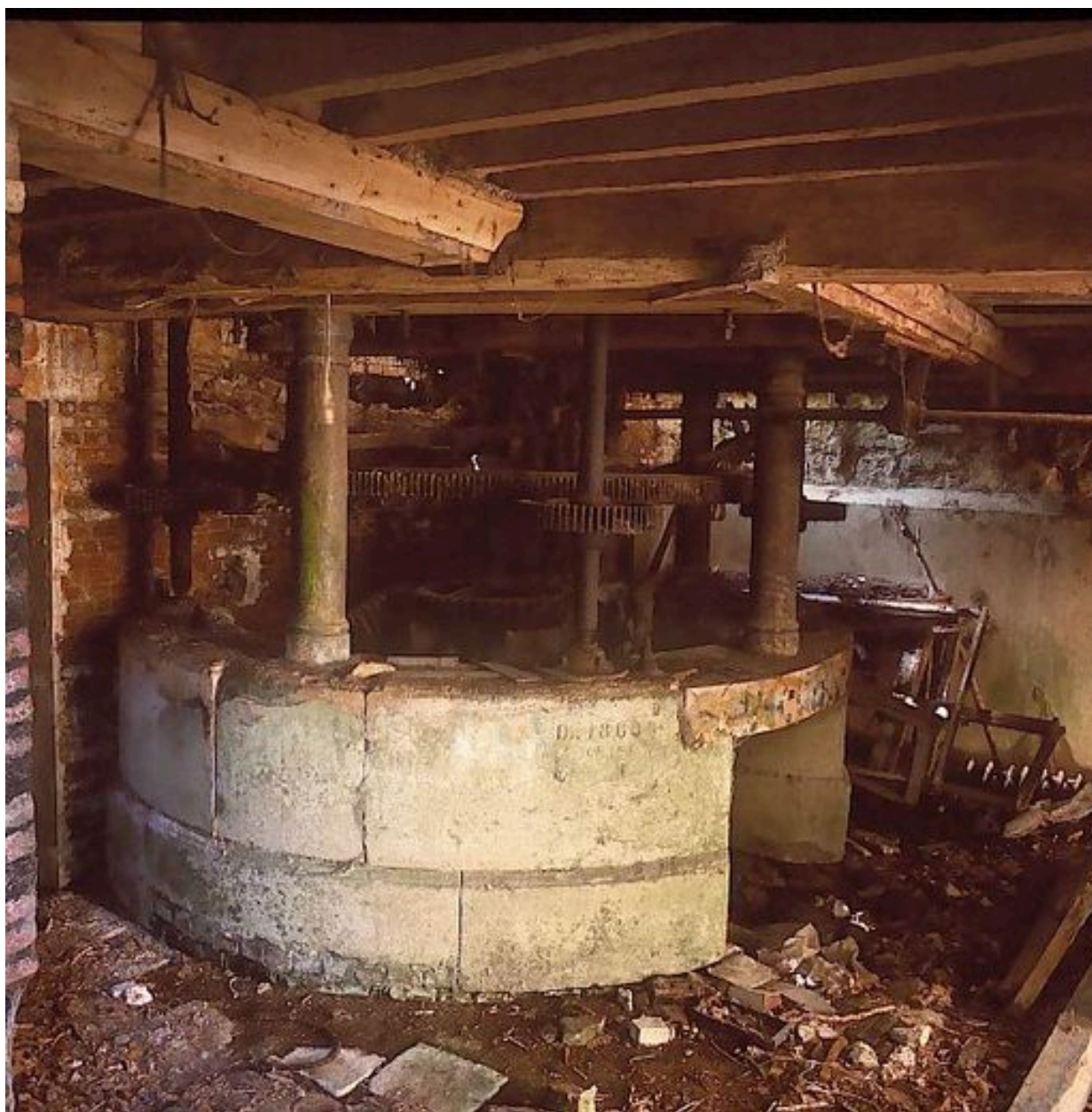
Intérieur du moulin, détail du beffroi et du mécanisme principal de transmission.
