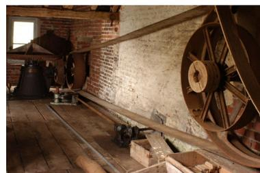
Intérieur de la salle des machines, vue d'ensemble de la turbine et de la transmission principale.
