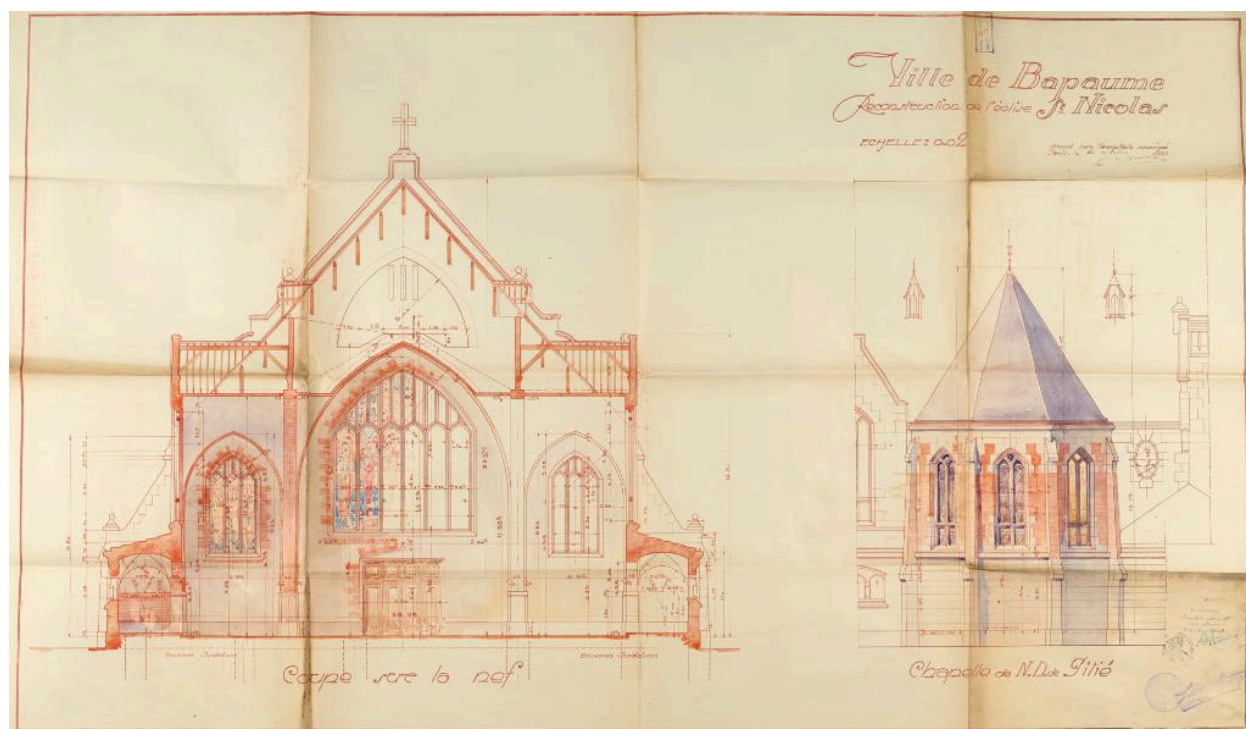
Ville de Bapaume - Reconstruction de l'église Saint-Nicolas : coupe sur la nef ; chapelle N.D. de Pitié. Dessin aquarellé, signé et daté, Eugène Bidard, 5 octobre 1929.
