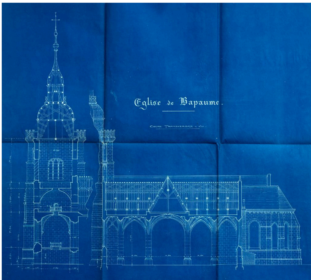
Église de Bapaume - Coupe transversale. Ni daté ni signé. (AD Pas-de-Calais, 10R21/52) : relevé de l'intérieure de la tour-clocher et du transept avant-guerre.
