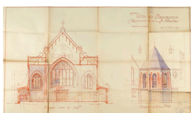
Ville de Bapaume - Reconstruction de l'église Saint-Nicolas : coupe sur la nef ; chapelle N.D. de Pitié. Dessin aquarellé, signé et daté, Eugène Bidard, 5 octobre 1929. Phot. Thibaut Pierre (reproduction) IVR32_20216200148NUCA
