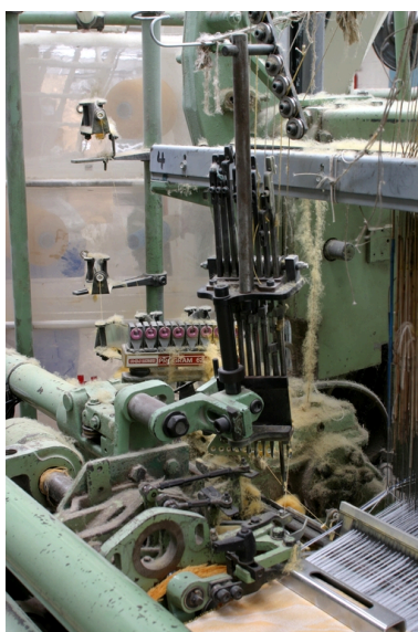
Mécanismes de sélection des fils de trame et de la lance d'entrée. En arrière-plan, les bobines de fil de trame. Phot. Frédéric Pillet IVR22_20040201128NUCA
