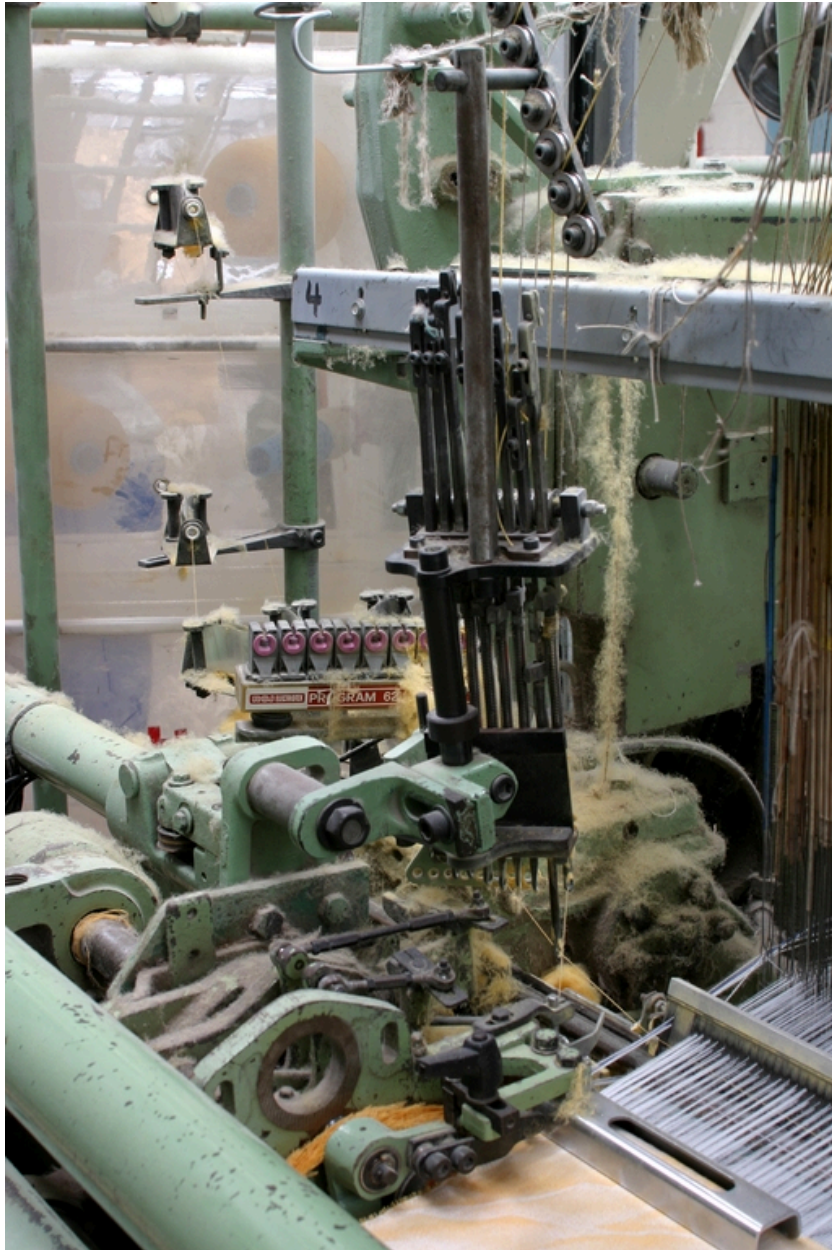
Mécanismes de sélection des fils de trame et de la lance d'entrée. En arrière-plan, les bobines de fil de trame.
