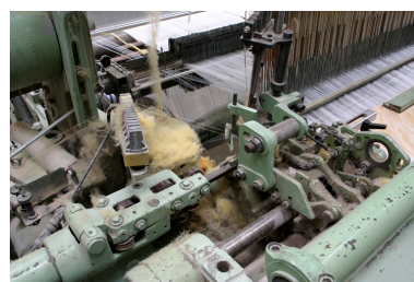
La lance d'entrée stopée en pleine action : on la distingue, dans la foule, entre le peigne et la ligne de façade (endroit de la frappe du peigne). On distingue bien l'action des lisses séparant la chaîne en deux nappes et formant la foule. Phot. Frédéric Pillet IVR22_20040201129NUCA
