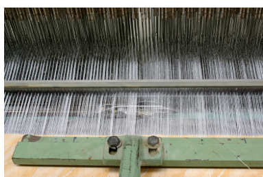
La lance d'entrée entraîne le fil de trame formant la duite (fil orange, perpendiculaire à la chaîne et parallèle au peigne) vers le centre du métier, où il sera repris par la lance de sortie. A l'arrière, les lisses. Phot. Frédéric Pillet IVR22_20040201130NUCA
