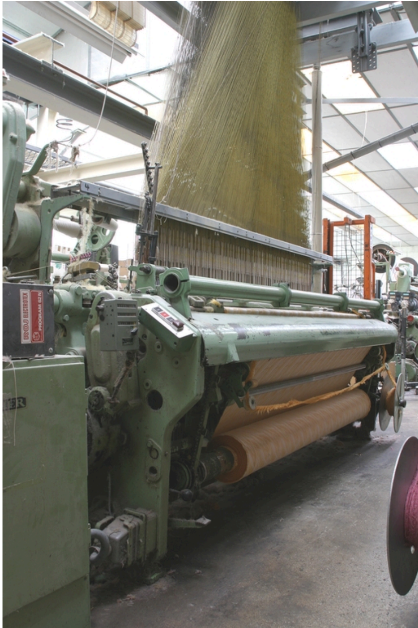
Face avant de la machine à tisser : en bas, le rouleau toilier ; au-dessus, les arcades reliant les lisses à la mécanique Jacquard..
