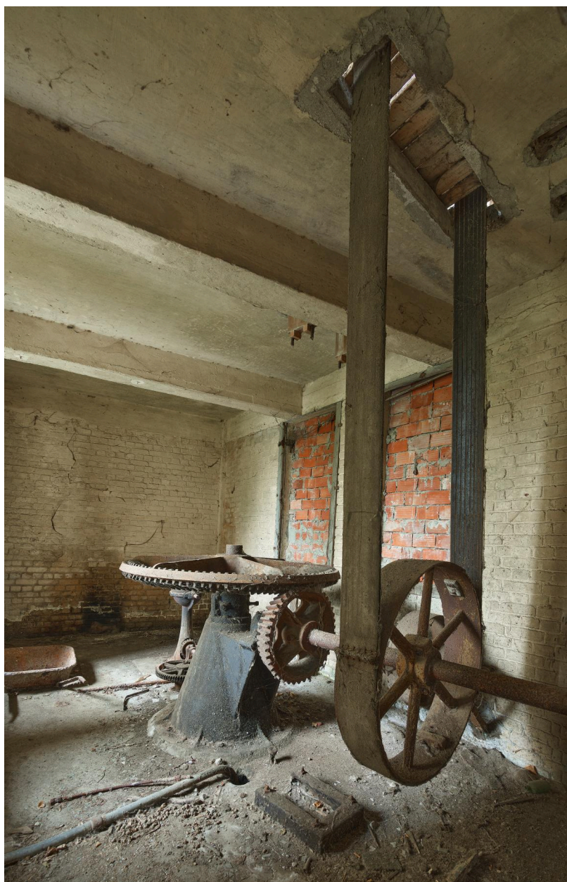
Turbine et sa courroie de transmission.
